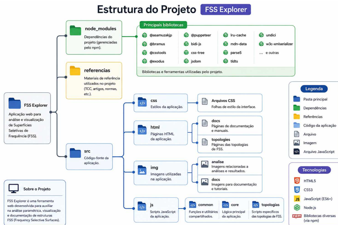
Figura 9 – Estrutura de diretórios e arquitetura geral do simulador FSS Explorer.
