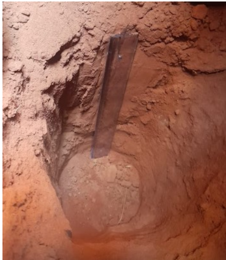
Figura 17 - Vala menor com 30 cm de altura, comprimento e largura
