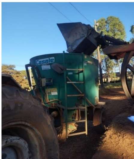
Figura 4. Vagão misturador vertical Casale® modelo Vertmix Piccola 35.
