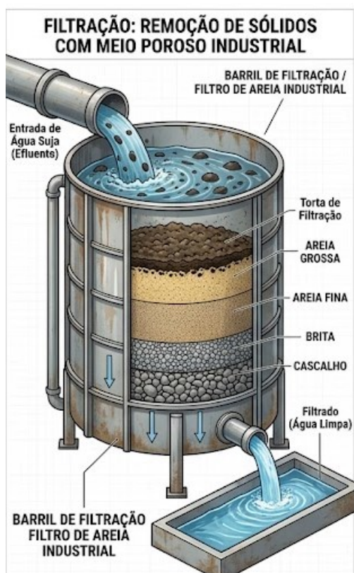
Figura 5 – Visualização interna de um filtro utilizado em lavouras.
