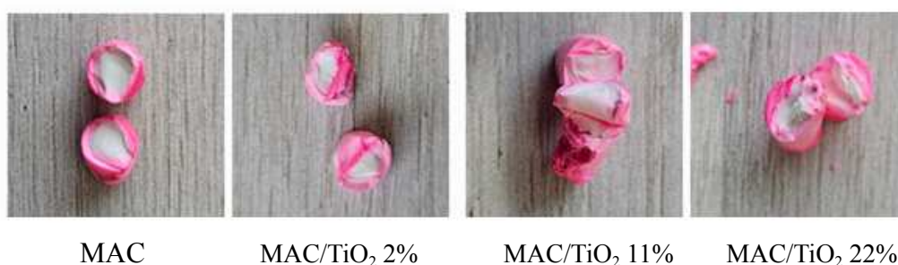
Figura 38. Distribuição da RhB adsorvido nos monolitos após os ciclos de adsorção/fotocatálise.
