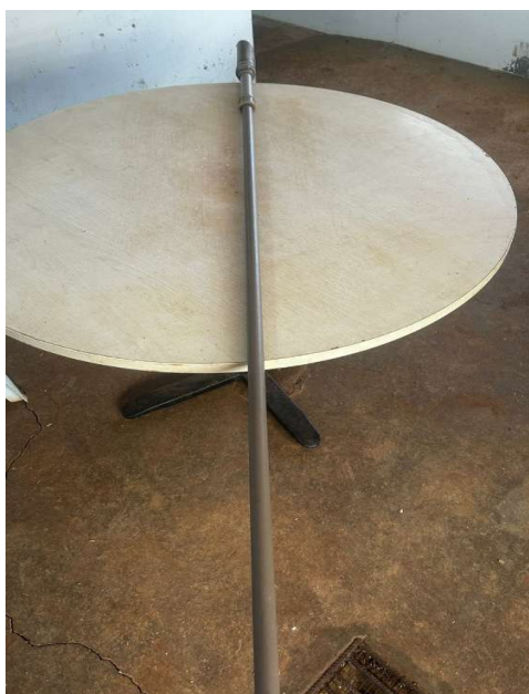
Figura 2. Cano de PVC (2,5 m comprimento) utilizado para amostrar diferentes pontos do micélio.
