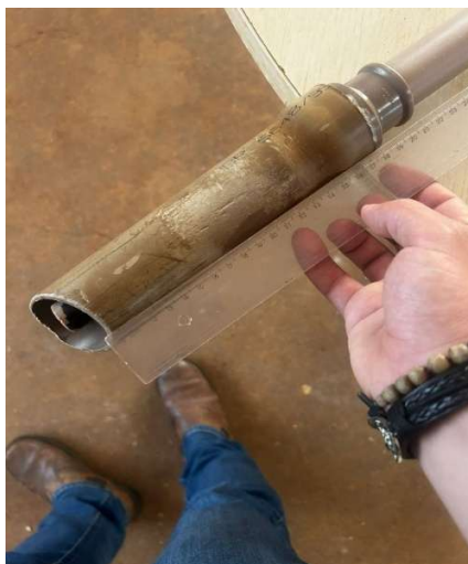
Figura 3. Altura da boca da ferramenta de coleta das amostras (15cm).
