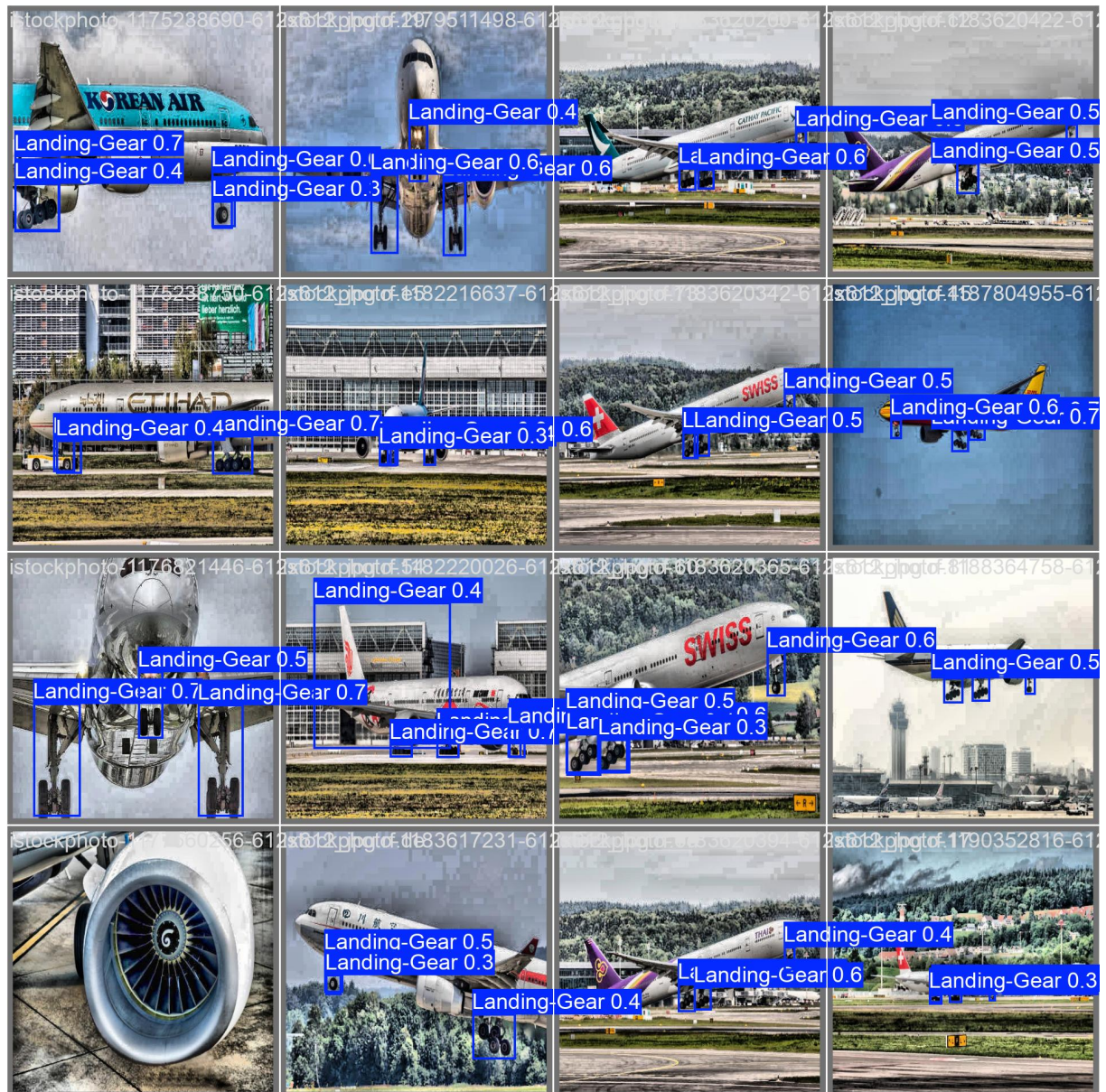
Figura 14 – Predições do YOLO11s no lote de validação. Cada caixa delimitadora é acompanhada do score de confiança da detecção.
