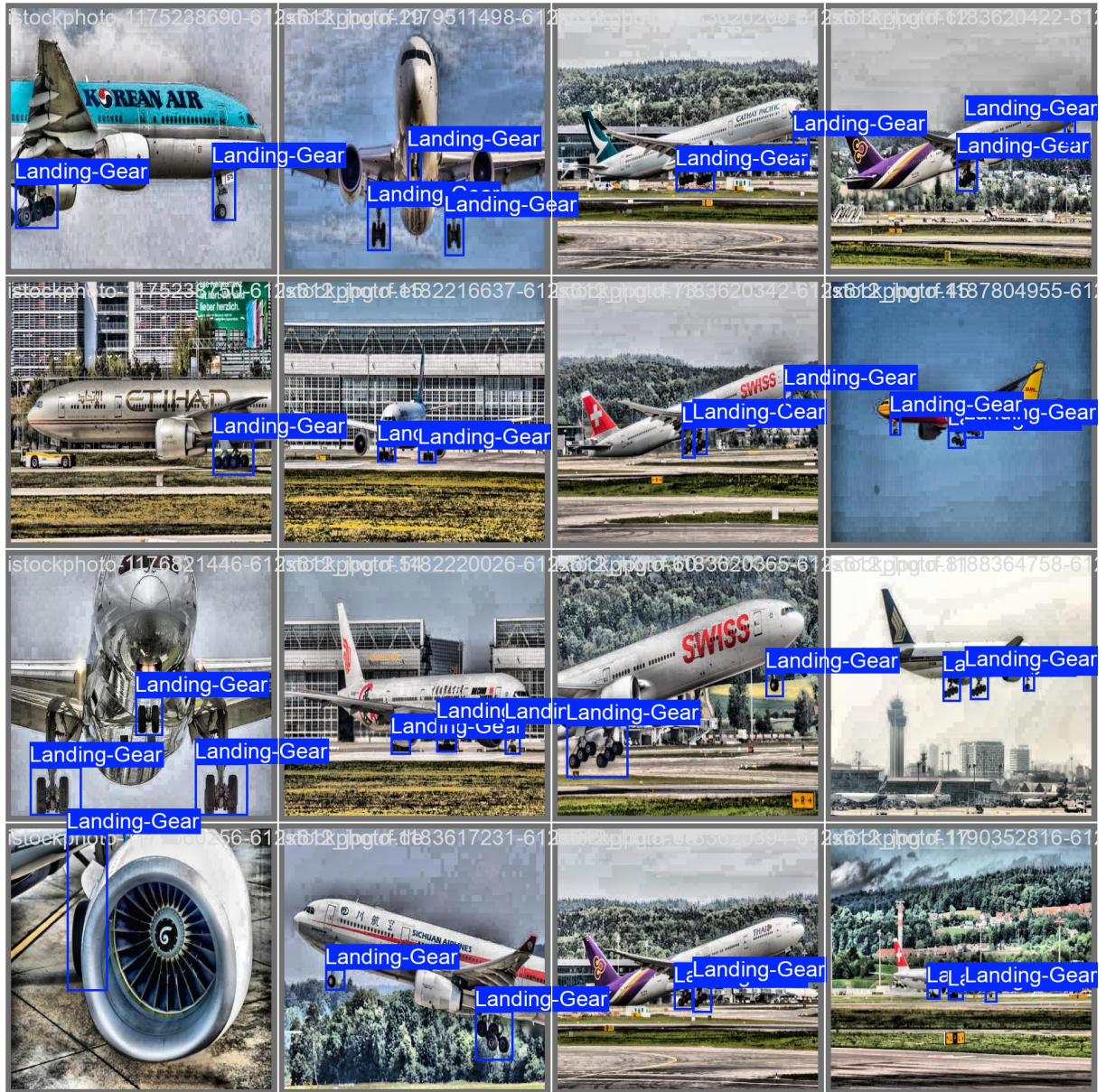
Figura 13 – Anotações de referência ( ground truth ) do lote de validação. As caixas delimitadoras indicam todas as instâncias de landing_gear anotadas manualmente no dataset.
