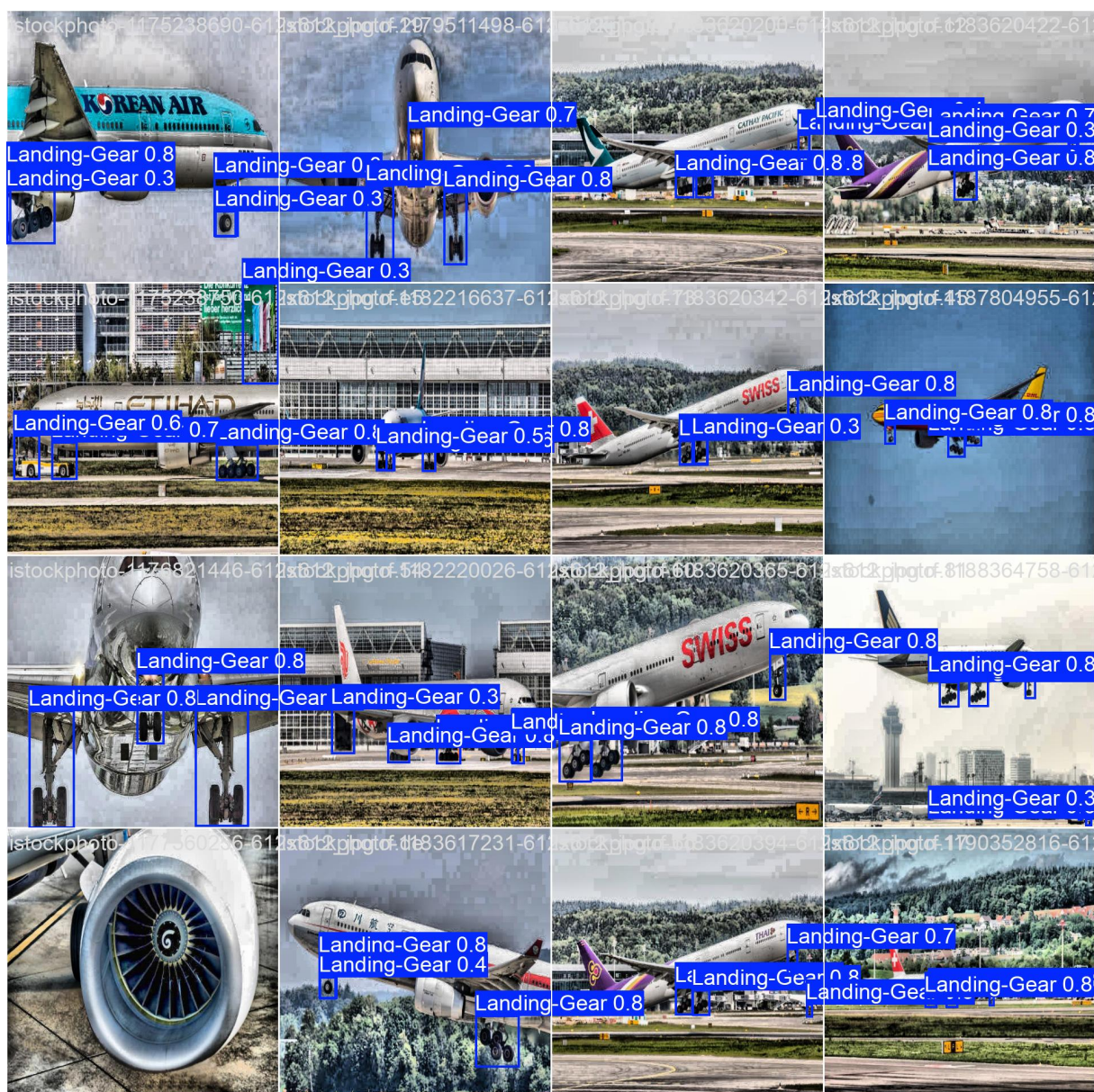
Figura 15 – Predições do RT-DETR-L no mesmo lote de validação. Observar os scores de confiança geralmente mais elevados em comparação ao YOLO11s, reflexo do limiar ótimo mais alto (0,603 vs 0,450).
