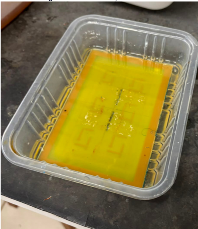
Figura 123 - Remoção da tinta
