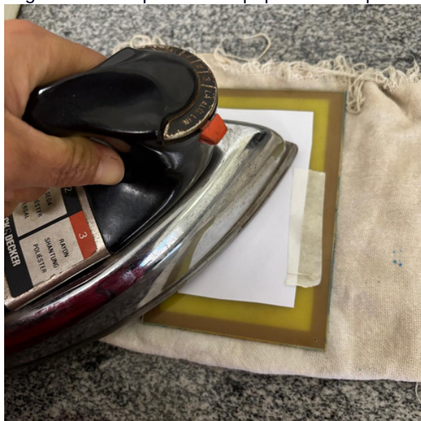
Figura 127 - Aquecendo o papel sobre a placa
