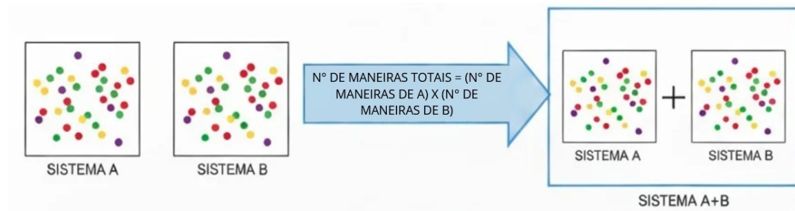
Figura 1.2: Ilustração da propriedade de aditividade para sistemas independentes. O número total de microestados do sistema composto ( A+B ) é o produto do número de microestados de cada subsistema.
