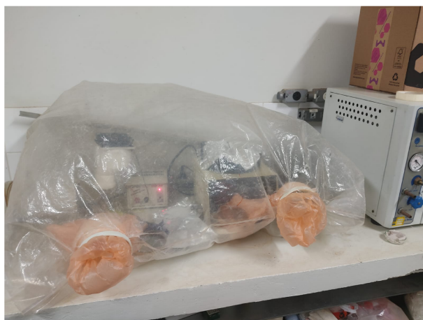
Figura 18 – Câmara de atmosfera controlada ( glove-box adaptada) contendo a spin-coater .
