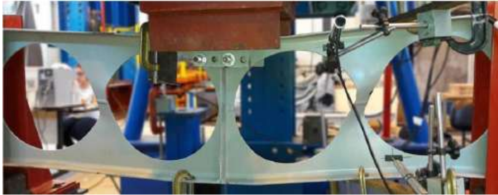
Figura 2.11 - Instabilidade no montante de alma por cisalhamento
