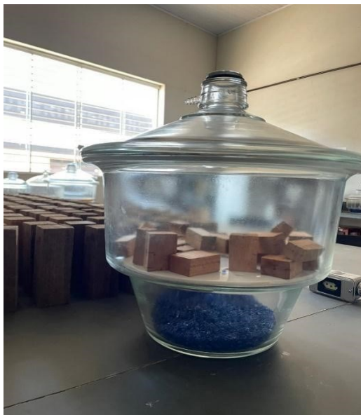
Figura 9: Resfriamento dos corpos de prova em dessecador hermético. Fonte: Letícia Benette
