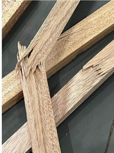
Figura 10: Execução dos ensaios de flexão dos corpos de prova. Fonte: Letícia Benette
