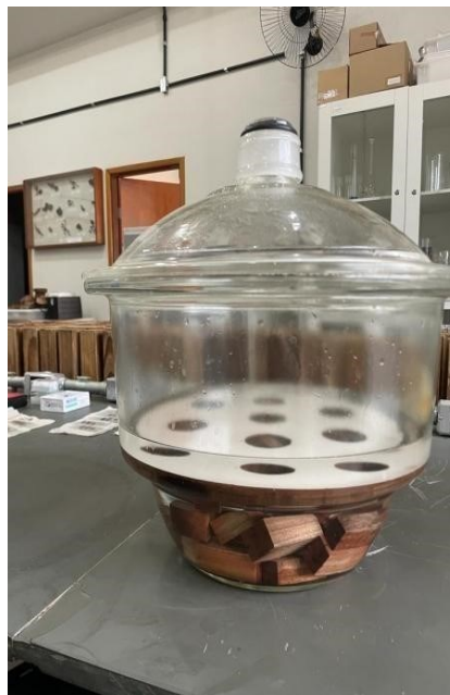
Figura 6: Corpos de prova em saturação por 30 dias em câmara de vácuo. Fonte: Letícia Benette
