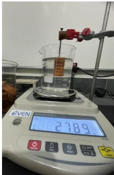
Figura 7: Determinação do volume dos corpos de prova através do deslocamento da água na balança hidrostática, conforme NBR 11941:2003. Fonte: Letícia Benette
