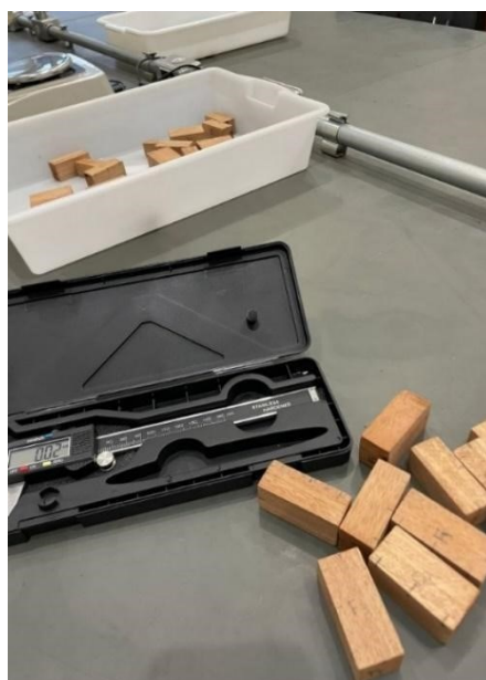
Figura 5: Corpos de prova sendo dimensionadas com o paquímetro digital. Fonte: Letícia Benette
