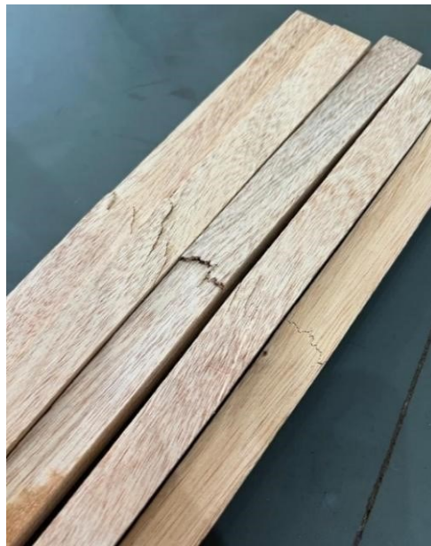
Figura 11: Ruptura dos corpos de prova. Fonte: Letícia Benette
