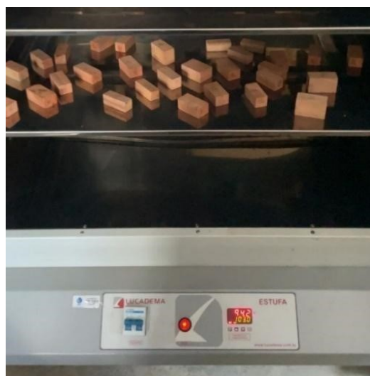
Figura 8: Secagem dos corpos de prova em estufa a 100 \pm 2 °C por 24 horas. Fonte: Letícia Benette
