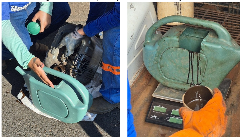
Figura 9. Determinação da quantidade de emulsão por faixa
