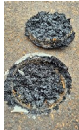
Na mistura asfáltica nova
