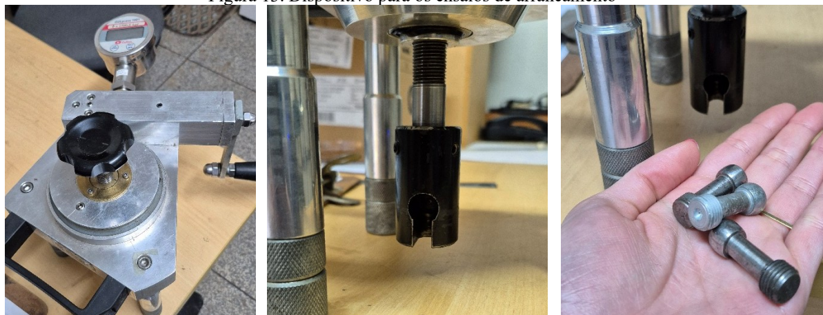
Figura 13. Dispositivo para os ensaios de arrancamento
