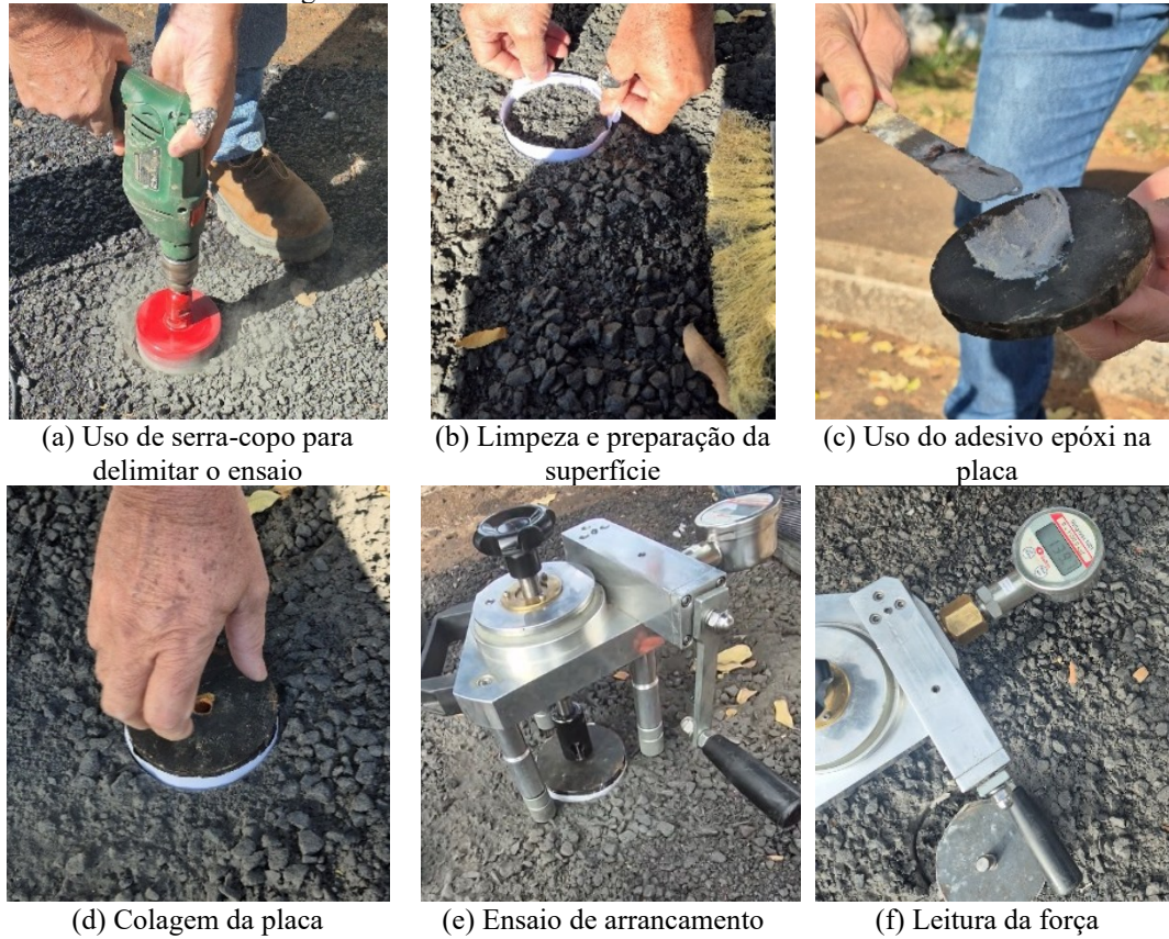
Figura 22. Procedimento do ensaio de arrancamento
