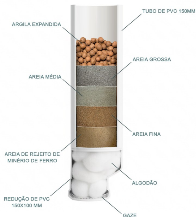
Figura 10: Esquema de corte transversal do filtro de areia Fonte: Autor (2025)
