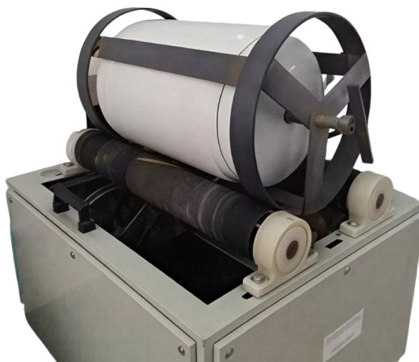
Figura 3.1 - Moinho de bolas de escala laboratorial.
