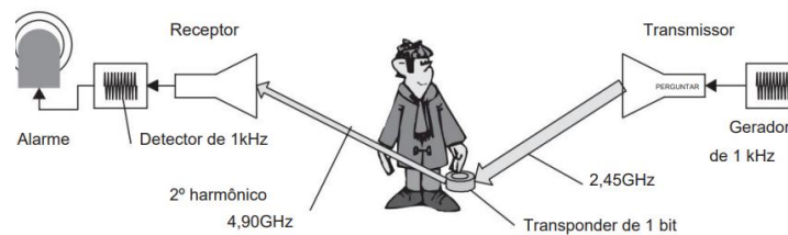
Figura 17: Etiqueta de microondas na zona de interrogação de um detector.
