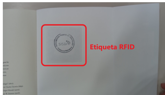
Figura 1: Etiqueta RFID, colada na contra capa do livro.
