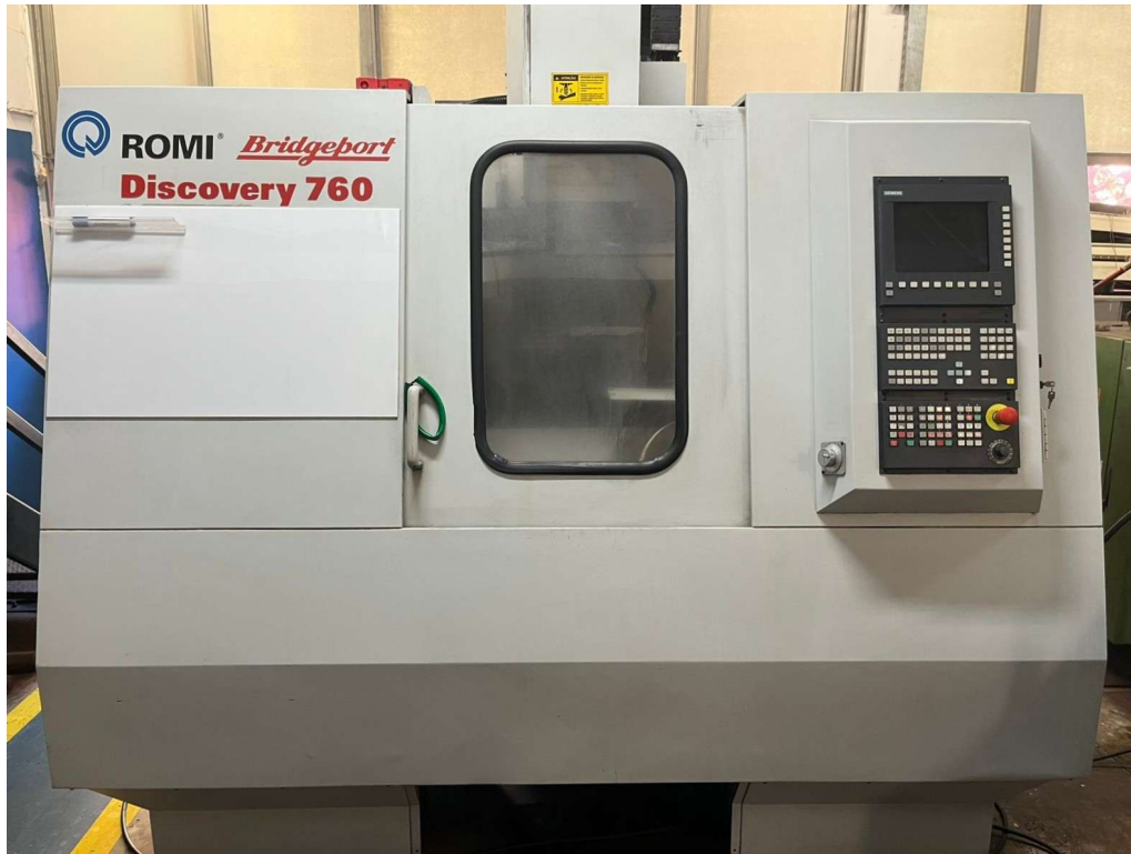
Figura 3.11. Centro de usinagem ROMI Discovery 760 utilizado nos ensaios.
