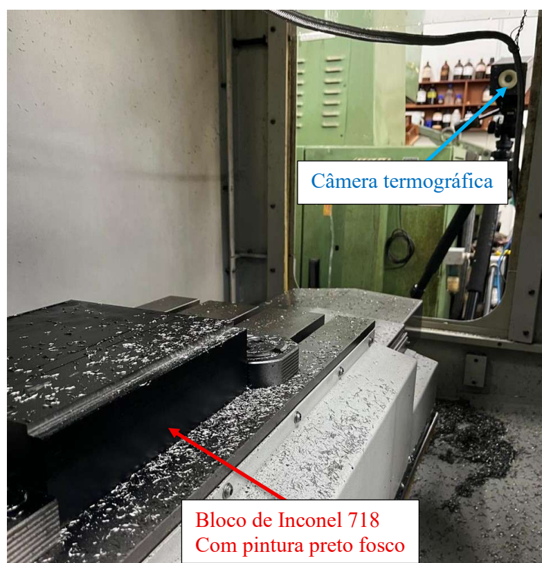
Figura 3.15. Detalhe da montagem do sistema de medição de temperatura por câmera termográfica infravermelha.
