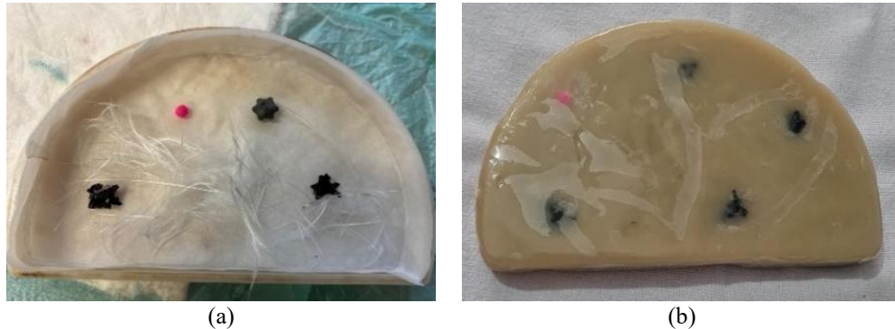
Figura 29 - (a) Molde com nódulos e fibras de vidro, preparado para colocar a mistura (b) Placa de cera de abelha e parafina em gel, com nódulos e fibras de vidro.
