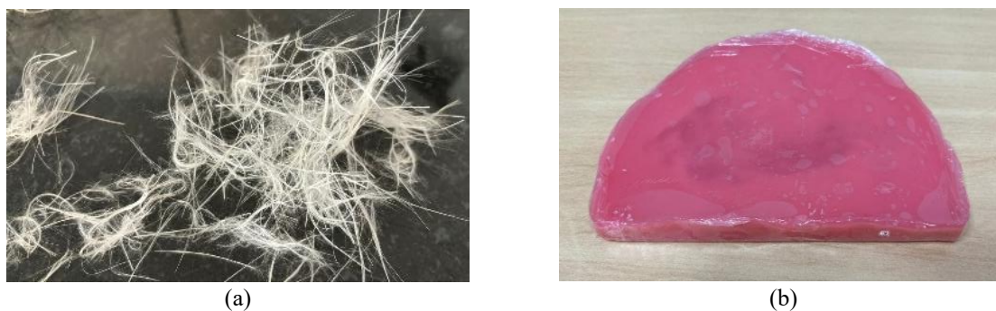
Figura 25 - (a) Fibras de vidro desfiadas para serem inseridas na placa. (b) Placa de Cera Odontológica e Parafina em Gel com fibra de vidro.
