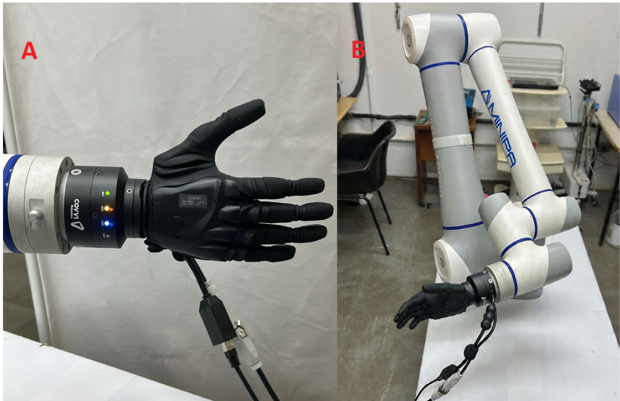
Figura 3.5: Prótese COVVI Robotic Hand acoplada ao braço robótico DOBOT CR10A. A) Vista lateral. B) Vista geral.
