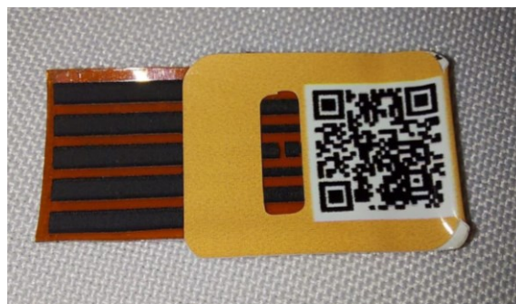
Figura 3. Foto do eletrodo de grafeno desenvolvido na pesquisa.
