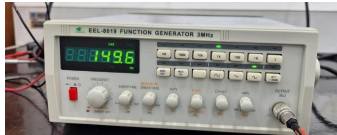
Figura 14: Gerador de funções utilizado como sinal sintético para testes do protótipo. Fonte: Autora.
