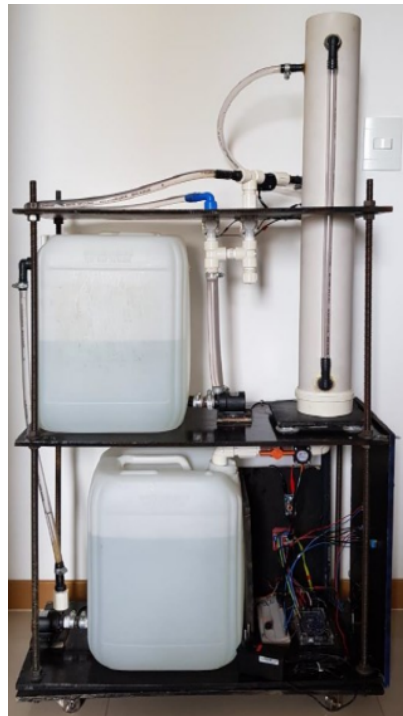
Figura 4 – Controle de tanques acoplados (PIMENTEL, 2024).
