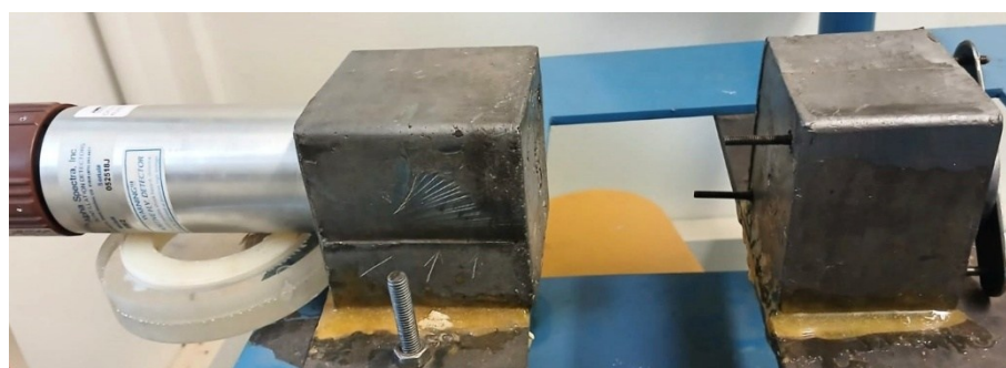
Figura 3.12 - Sistema de detecção com a fonte aberta e sem meio atenuante para obter I_0 . Fonte: elaborado pelo autor.
