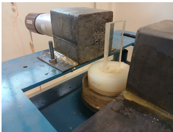
Figura 3.10 - Sistema de detecção com a placa de acrílico (meio atenuante B) utilizada para obter I_B . Fonte: elaborado pelo autor.
