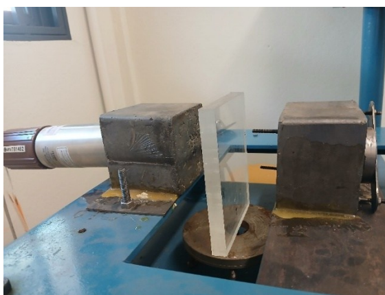
Figura 3.9 - Sistema de detecção com a placa de acrílico (meio atenuante A) utilizada para obter I_A . Fonte: elaborado pelo autor.
