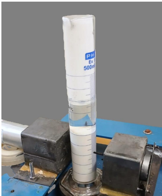
Figura 4.25 - Sistema montado para a análise do sedimento da suspensão de barita a 30% (v/v), com a proveta posicionada entre o detector e a fonte de radiação gama. Fonte: Elaborado pelo autor.
