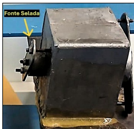
Figura 3.7 - Bloco de chumbo vedado (fonte selada) contendo, em seu interior, o radioisótopo Césio-137. Fonte: elaborado pelo autor.
