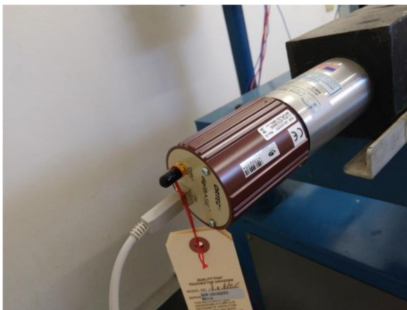
Figura 3.2 - Fotografia do sistema de detecção de radiação com digiBASE acoplado ao cristal de NaI(Tl). Fonte: adaptado de FAGUNDES (2019).
