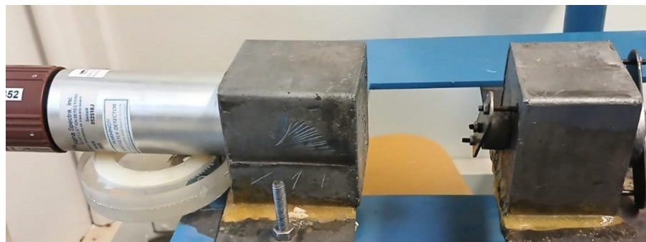
Figura 3.13 - Sistema de detecção com a fonte selada e sem meio atenuante para obter I_{BG} . Fonte: elaborado pelo autor.
