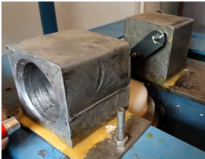
Figura 3.3 - Procedimento de verificação do alinhamento dos orifícios dos blocos de chumbo da fonte radioativa e do detector, utilizando ponteiro laser. Fonte: elaborado pelo autor.
