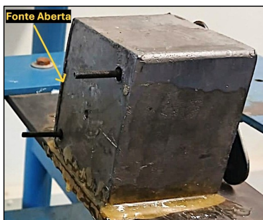
Figura 3.8 - Bloco de chumbo sem a tampa (fonte aberta) contendo, em seu interior, o radioisótopo Césio-137. Fonte: elaborado pelo autor.
