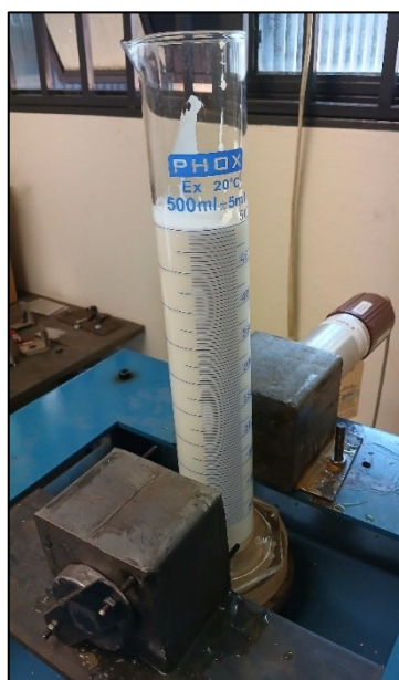
Figura 3.16 - Suspensão de BaSO 4 em goma xantana posicionada no sistema da TARG. Fonte: elaborado pelo autor.
