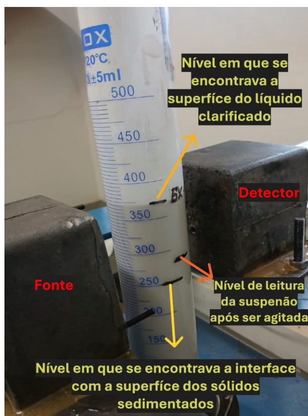
Figura 4.23 - Sistema de detecção de radiação gama com a proveta posicionada na TARG, indicando os níveis de leitura da região clarificada, da suspensão ressuspensa e da interface dos sólidos sedimentados. Fonte: Elaborado pelo autor.
