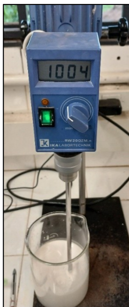
Figura 3.15 - Suspensão de BaSO 4 em goma xantana sendo agitada no misturador de hélice (Ika RW 20D2Mn) à 1000 rpm. Fonte: elaborado pelo autor.
