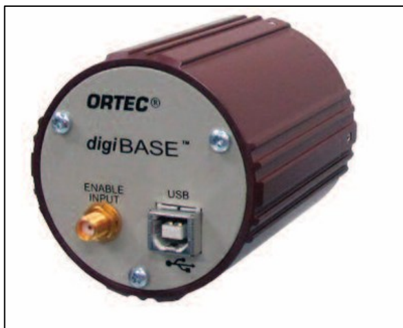
Figura 2.4 - digiBASE All-in One PMT Base, HV, Pré-amplificador, Amplificador e MCA Digital . Fonte: ORTEC (2009).
