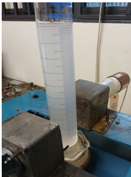
Figura 3.14 - Sistema de detecção com a proveta de teste contendo apenas solução de goma xantana 0,2% m/m. Fonte: elaborado pelo autor.
