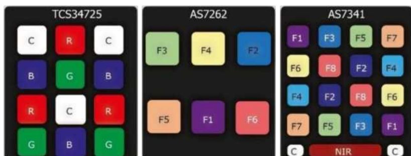
Figura 6. Diagrama representativo da posição de cada um dos filtros nos sensores de cor
