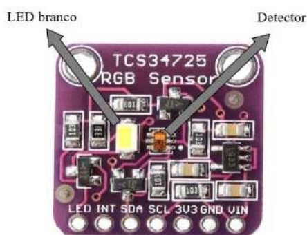
Figura 2. Foto do sensor TCS34725 indicando o posicionamento do detector e do LED.
