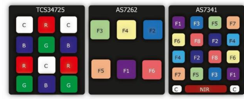
Figura 6. Diagrama representativo da posição de cada um dos filtros nos sensores de cor
