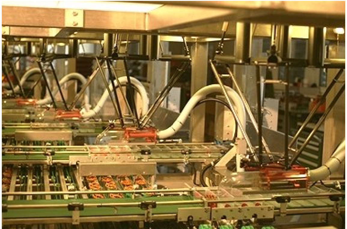
Figura 2.9: Robôs Delta trabalhando na indústria alimentícia.
