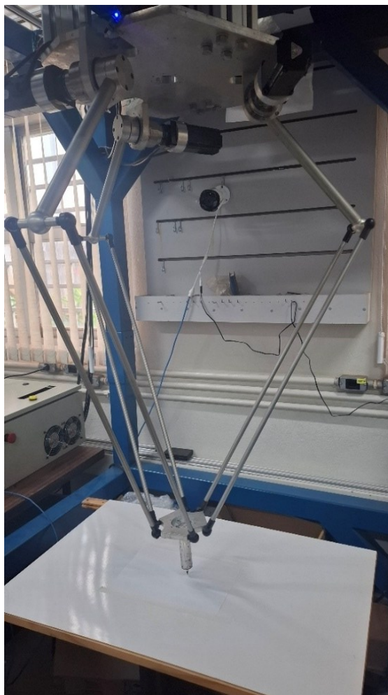
Figura 3.2: Estrutura do Robô Delta do Laboratório de Automação e Robótica.
