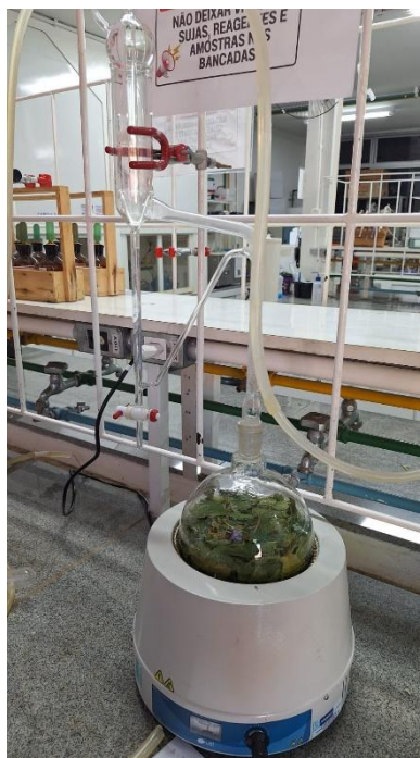
Figura 16 – Foto do aparelho Clevenger utilizado na hidrodestilação.
