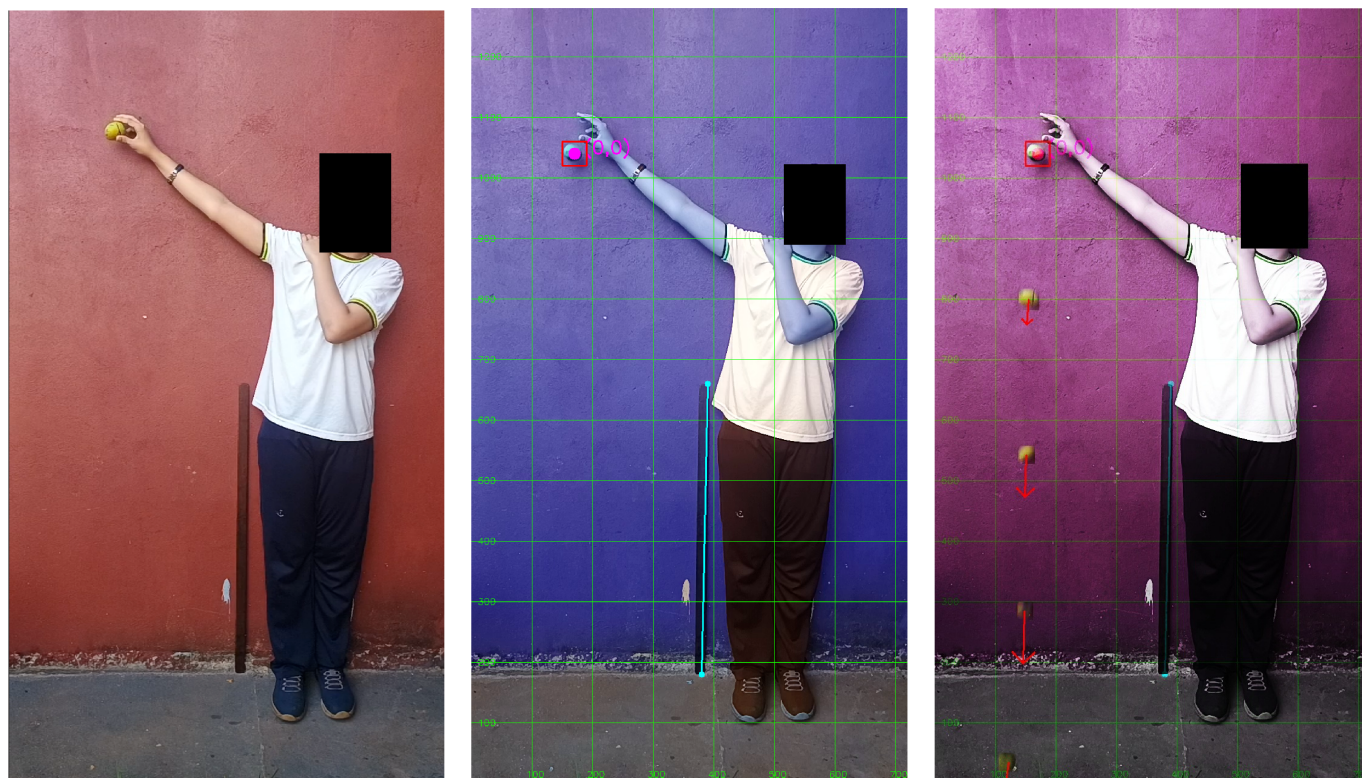
Figura 2.5 – Queda livre de uma manga: (a) frame inicial; (b) imagem de configuração; (c) imagem vetorial estroboscópica.
