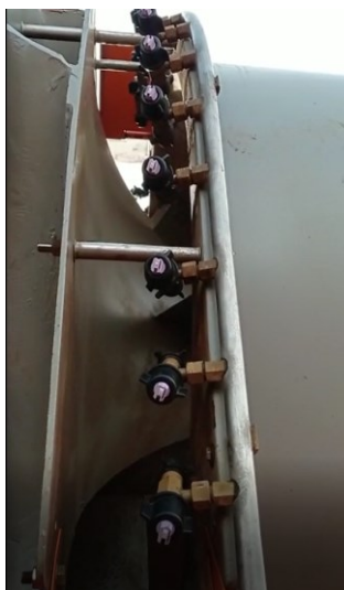
FIGURA 5. Otimização do padrão de deposição para pontas de jato plano: ajuste angular de 15^\circ para prevenir a distorção do jato e assegurar a uniformidade da distribuição ao longo do arco de pulverização
