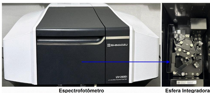
Figura 24 – Fotografia do espectrofotômetro e da esfera integradora utilizados na aquisição dos espectros de absorção óptica. Fonte: Produzida pelo próprio autor.
