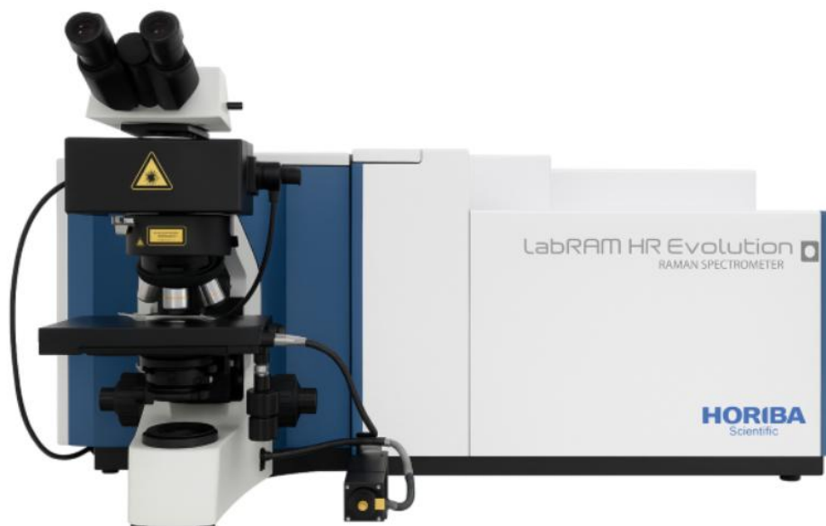
Figura 23 – Imagem ilustrativa do espectrômetro Raman confocal utilizado na aquisição dos espectros Raman. Fonte: Referência [112].
