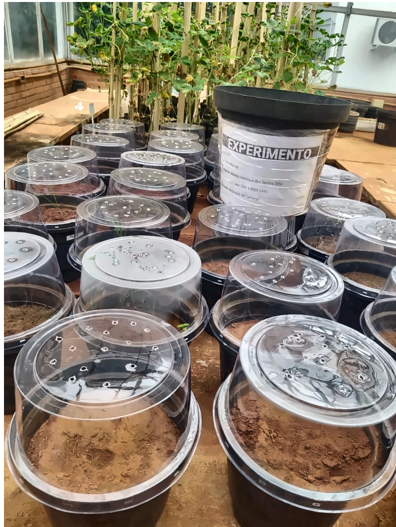
Figura 2 - Cobertura dos vasos para controle hídrico e redução da evaporação. Fonte: Elaborado pelo autor.
