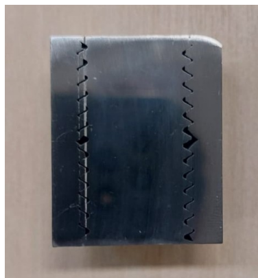
Figura 5.1 – Recorte transversal do contato entre os filetes parafuso-porca.
