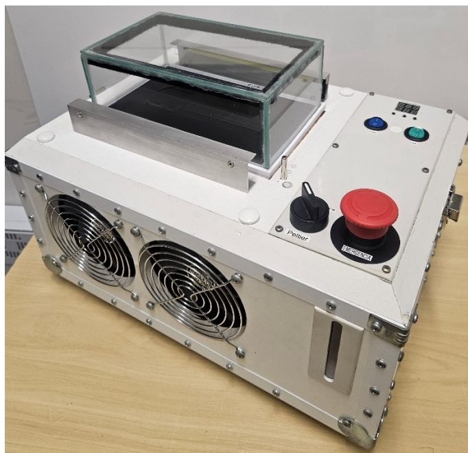
Figura 4 - Montagem final do protótipo otimizado da câmara de nuvens (O autor, 2025).
