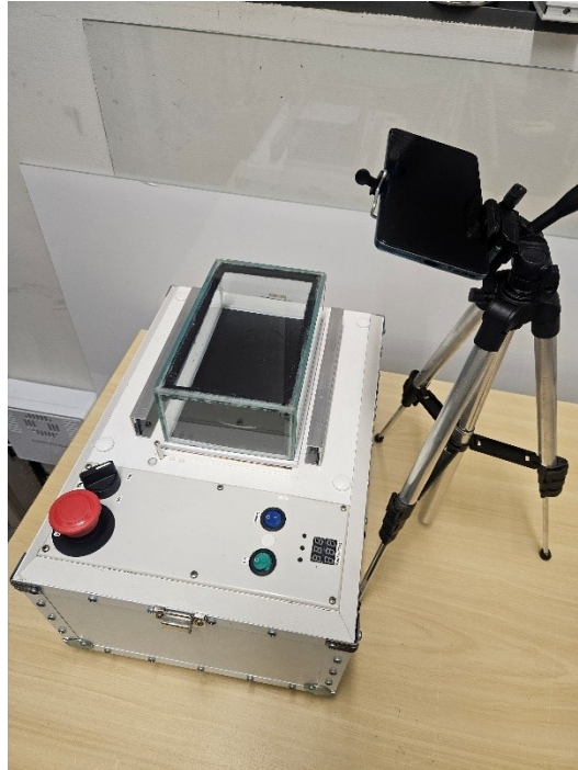
Figura 10 - Arranjo experimental ( setup ) para aquisição de dados, demonstrando a câmera otimizada e o smartphone em tripé fixo (O autor, 2025).
