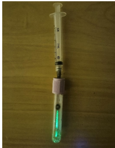
Figura 9 – Ponteiro de relógio com ^{226}\text{Ra} demonstrando fluorescência sob luz ultravioleta (UV) e selado em tubo a vácuo para coleta de Radônio (O autor, 2025).
