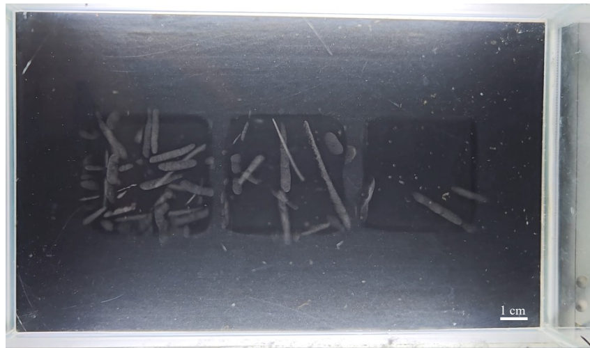
Figura 15 - Traços de decaimento do gás ^{222}\text{Rn} e seus descendentes (O autor, 2025).
