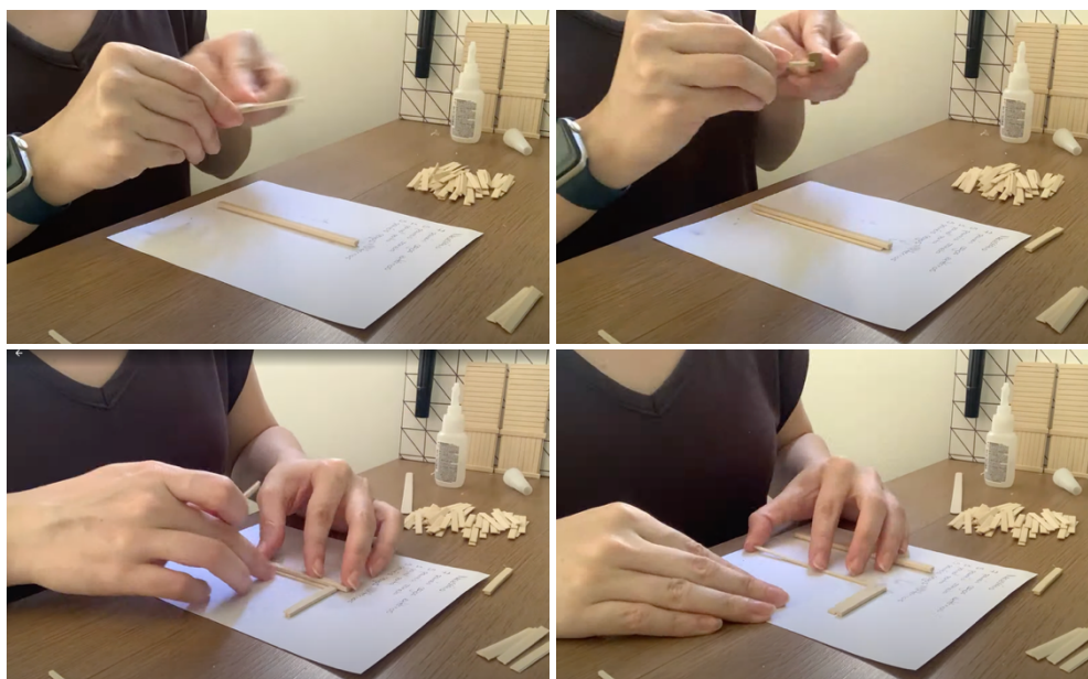
Figura 61 - Montagem do painel de vedação vertical com o gabarito.
