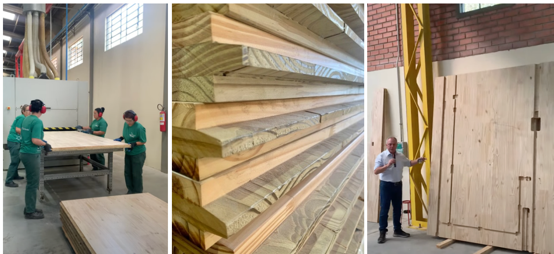
Figura 7 - Sequência de imagens da produção de CLT com madeira de reaproveitamento.
