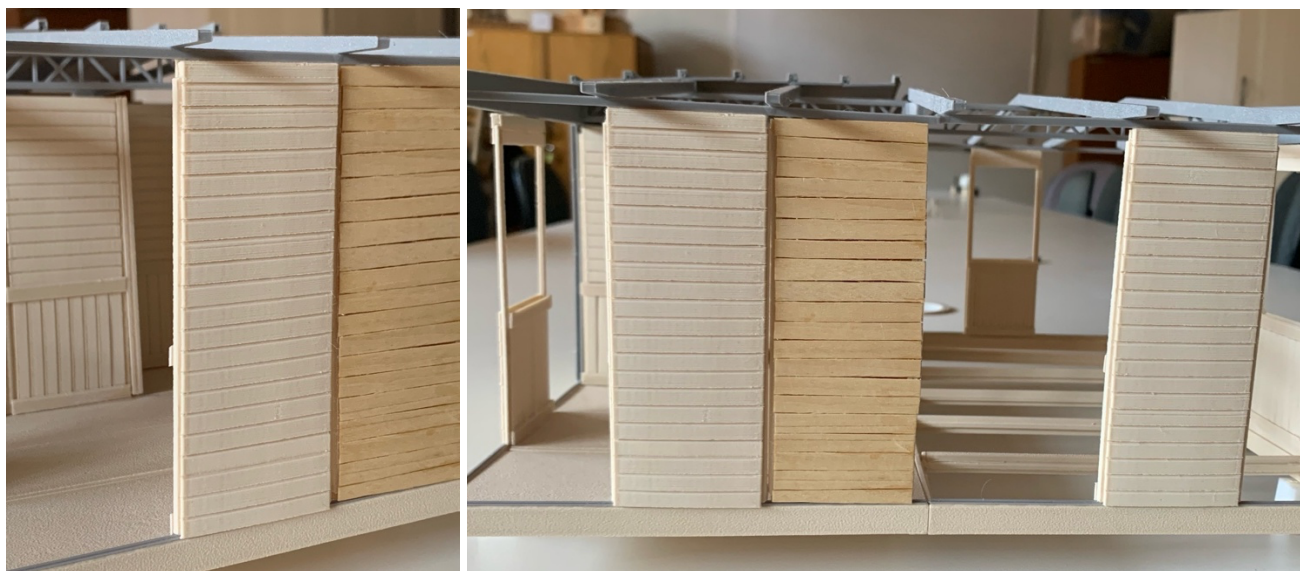
Figura 65 - Imagens comparativas dos painéis de vedação vertical prototipados em impressão 3D e em lâmina de madeira.
