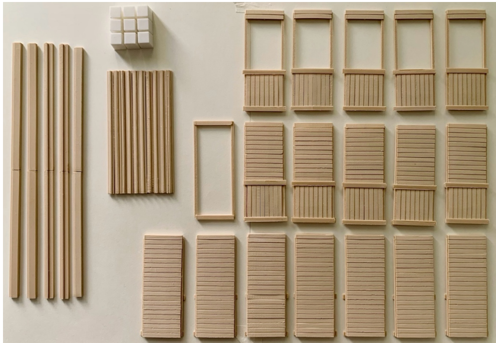
Figura 62 - Componentes de madeira – Modelo Reduzido Construção desmontável para vítimas de guerra 6x6.
