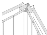
b - conexão painéis de canto externos
