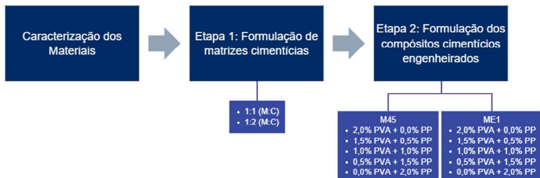
Figura 12 – Fluxograma das etapas desenvolvidas no programa experimental
