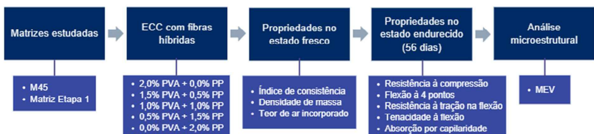
Figura 15 – Fluxograma dos procedimentos experimentais da Etapa 2.
