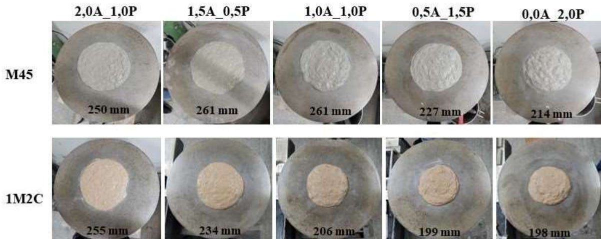
Figura 34 – Efeito da hibridização das fibras de PVA/PP no índice de consistência de compósitos cimentícios para as matrizes M45 e 1M2C.
