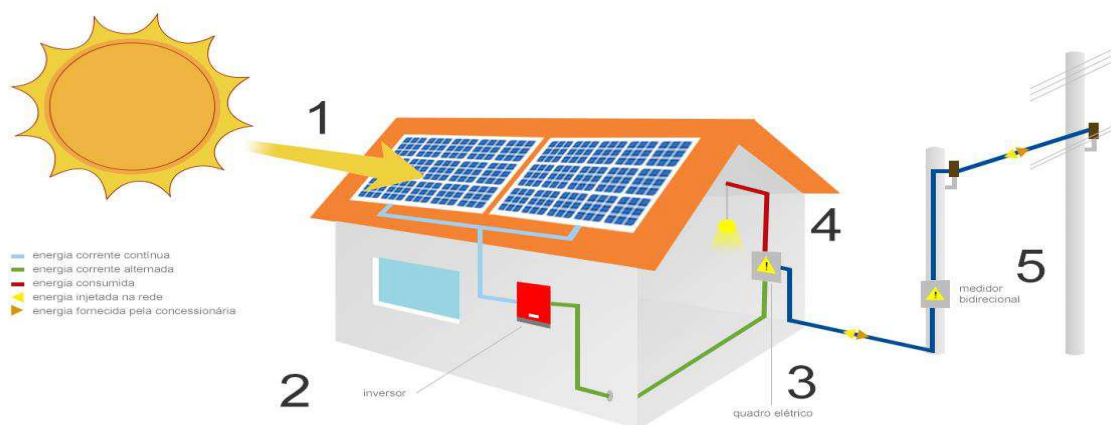
Figura 2 - Funcionamento Sistema Solar On-Grid
