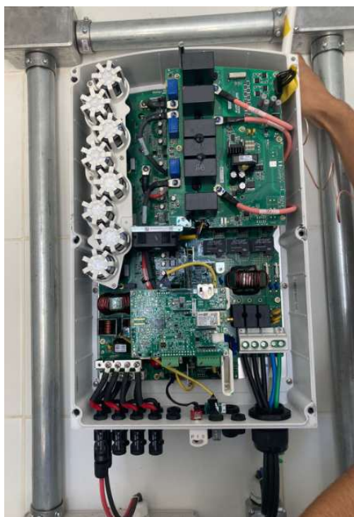
Figura 9 -Estrutura interna do inversor SE33.3K
