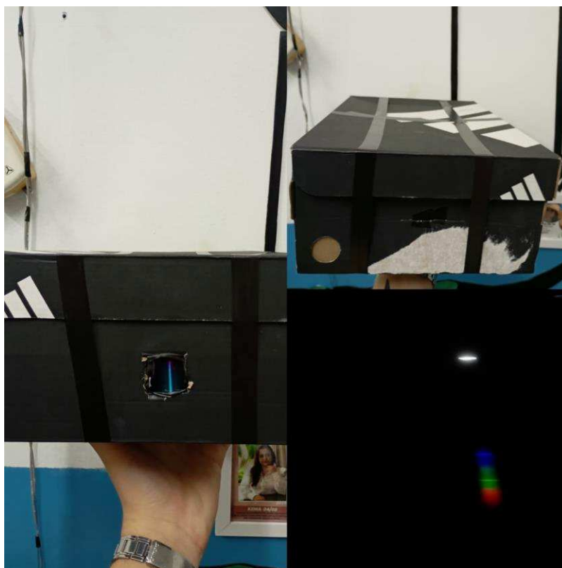
Figura 5 – Observação do espectro luminoso utilizando CD e caixa de sapato com fenda.
