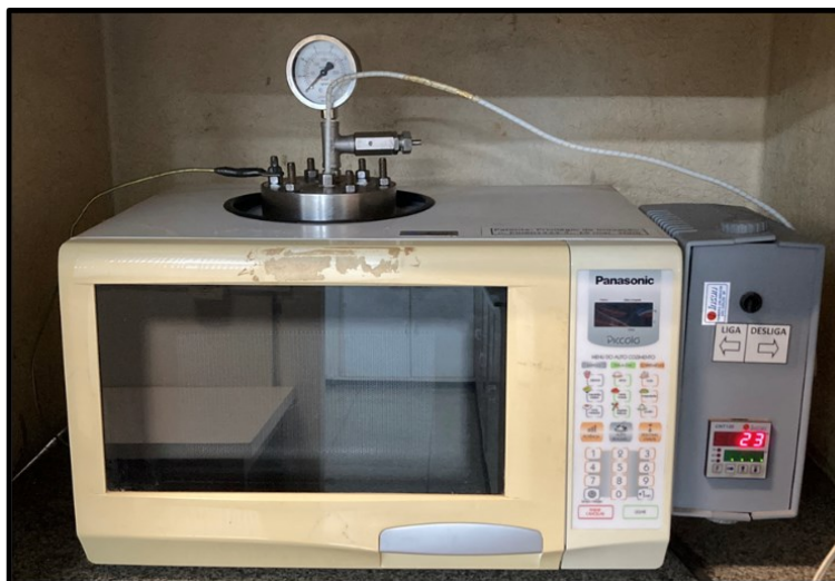
Figura 16 – Sistema hidrotérmico de micro-ondas aplicado na obtenção do \text{Bi}_2\text{O}_3 e dos materiais dopados.
