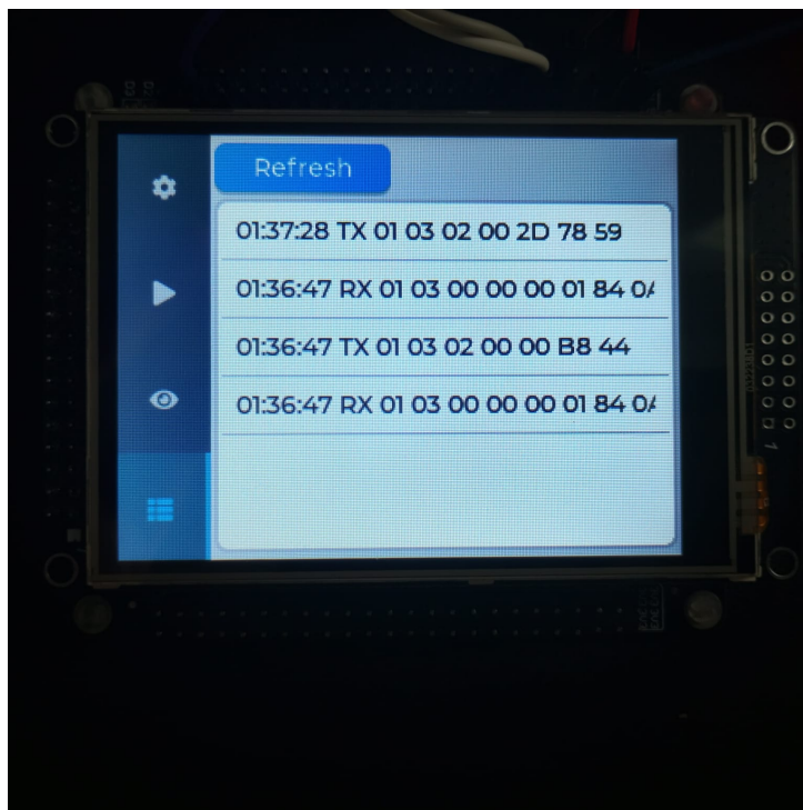
Figura 35 – Aba do terminal de diagnóstico exibindo os últimos quadros capturados pelo Sniffer.
