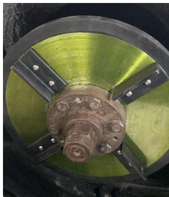
Figura 4.7. Roda de borracha com pás de agitação usadas nos ensaios de roda de borracha úmido. Fonte próprio autor.
