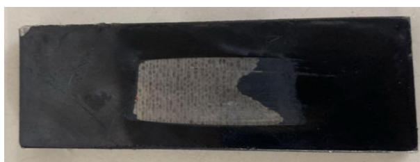
Figura 3.15. Desgaste total do revestimento de alcatrão de hulha, de 1 mm de espessura, pela aplicação de ensaios de roda de borracha úmido conforme a ASTM G105, utilizando partículas abrasivas de sílica com mistura tamanho de 200 \mu m e de 800 \mu m de diâmetro médio. Fonte próprio autor.
