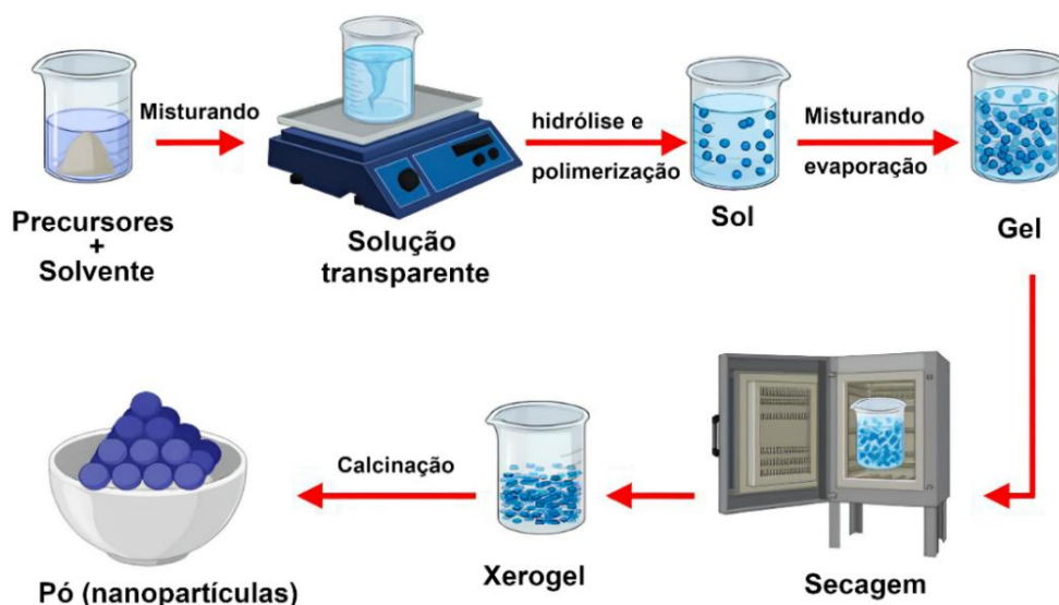
Figura 4 - Representação esquemática do processo de síntese sol-gel.
