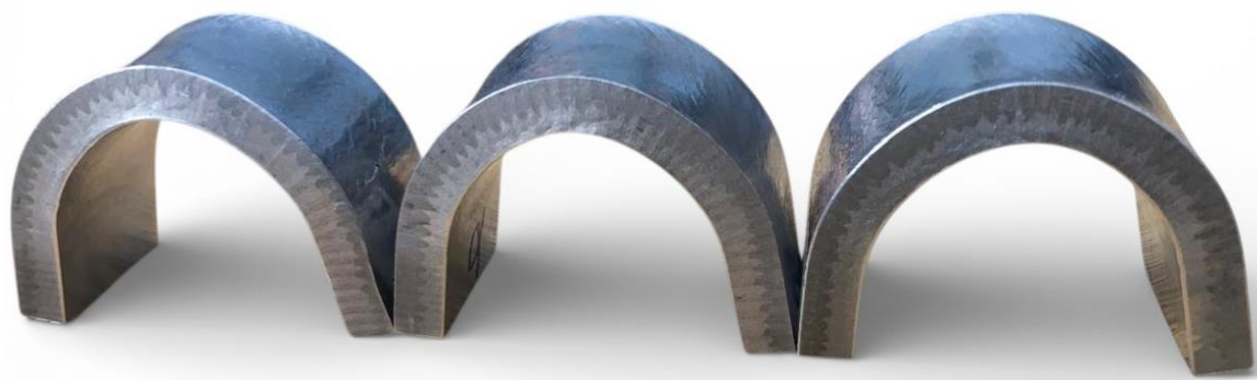
Figura 4.13 - Corpos de prova da parede cladeada ER70S-6/ER309L-Si, produzida com espaçamento de 50 mm entre as tochas, após o ensaio de dobramento (como escala adotar espessura de 10mm). Fonte: autor (2026)
