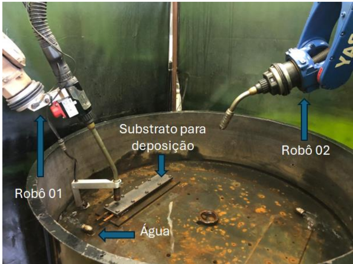
Figura 3.1 - Representação esquemática do campo de trabalho do sistema MADA, disposição dos robôs, do substrato metálico e da cuba de água empregada para controle térmico durante o processo. Fonte: autor (2026)
