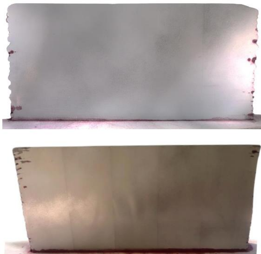
Figura 4.3 - Ensaio por líquido penetrante na pré-forma usinada (100mm entre tochas): com imagem superior correspondente ao aço carbono ER70S-6 e inferior ao aço inoxidável ER309LSi. Fonte: autor (2026)
