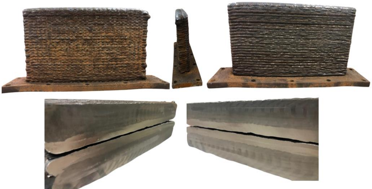
Figura 4.1 – Pré-formas produzidas via MADA, evidenciando a geometria final, dimensões e espessura do cladding, com aproximadamente 152 mm de altura, 270 mm de comprimento, 38 mm de espessura e 57 camadas depositadas. Fonte: autor (2026)
