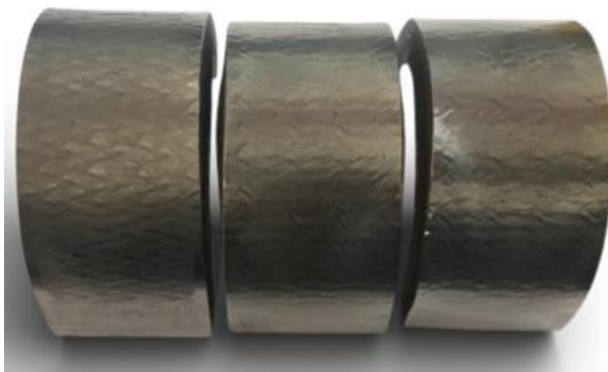
Figura 4.10 - Corpos de prova da parede cladeada ER70S-6/ER309L-Si, produzida com espaçamento de 100 mm entre as tochas, após o ensaio de dobramento (como escala adotar largura de 38 mm). Fonte: autor (2026)
