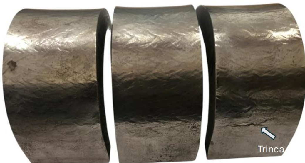
Figura 4.12 - Corpos de prova da parede cladeada ER70S-6/ER309L-Si, produzida com espaçamento de 50 mm entre as tochas, após o ensaio de dobramento (como escala adotar largura de 38 mm). Fonte: autor (2026)
