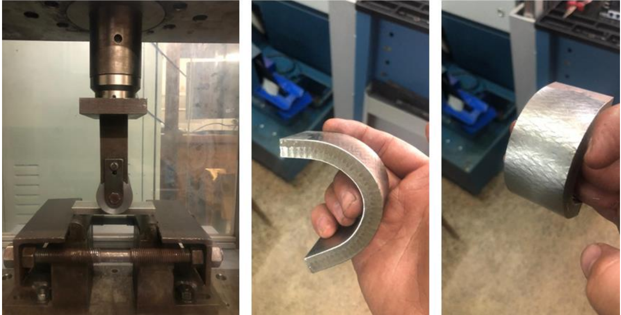
Figura 3.5 - Ensaio de dobramento guiado conforme ASTM A264: (a) cutelo de diâmetro 50 mm e posicionamento do corpo de prova antes do ensaio; (b–c) corpos de prova após o dobramento, evidenciando a condição da interface entre o revestimento e o material de base para avaliação do critério de aceitação. Fonte: autor (2026)
