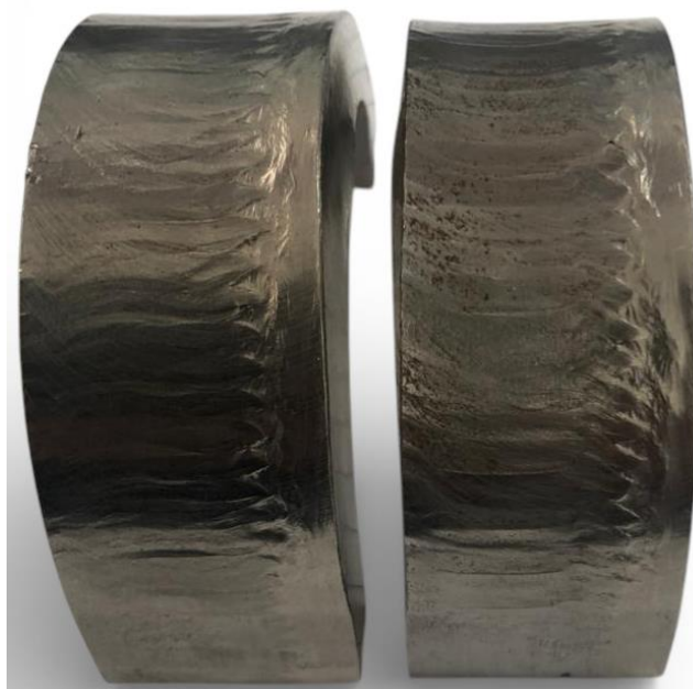
Figura 4.15 - Corpos de prova retirados da parede cladeada ER70S-6/ER309L-Si, produzida com espaçamento de 100 mm entre as tochas, destinados à realização de dobramentos adicionais para avaliação complementar da integridade interfacial. (como escala adotar largura de 28 mm). Fonte: autor (2026)
