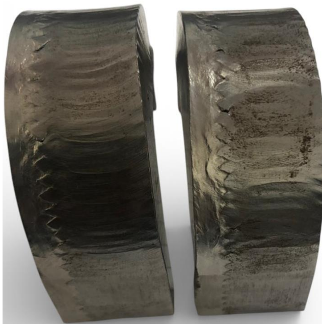
Figura 4.14 - Corpos de prova retirados da parede cladeada ER70S-6/ER309L-Si, produzida com espaçamento de 50 mm entre as tochas, destinados à realização de dobramentos adicionais para avaliação complementar da integridade interfacial. (como escala adotar largura de 28 mm). Fonte: autor (2026)
