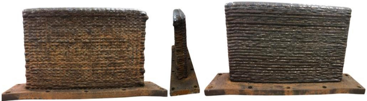
Figura 3.3 - Vista geral da pré-forma depositada por MADA, composta por 57 camadas, com dimensões finais aproximadas de 152 mm de altura e 270 mm de comprimento. Fonte: autor (2026)
