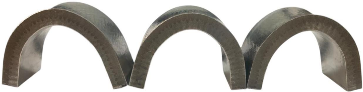
Figura 4.11 - Corpos de prova da parede cladeada ER70S-6/ER309L-Si, produzida com espaçamento de 100 mm entre as tochas, após o ensaio de dobramento (como escala adotar espessura de 10 mm). Fonte: autor (2026)
