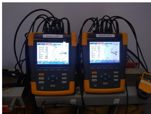
Figura 49 - (a) Fonte de tensão controlada e (b) Qualímetros utilizados para detecção das VTCDs.
