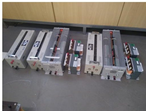
Figura 51 - (a) Cargas resistivas e (b) Indutâncias que foram chaveadas juntamente com os reostatos para gerarem as VTCDs do lado do secundário.
