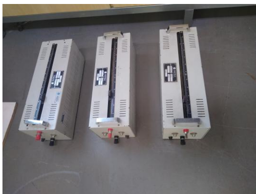
Figura 51 - (a) Cargas resistivas e (b) Indutâncias que foram chaveadas juntamente com os reostatos para gerarem as VTCDs do lado do secundário.
