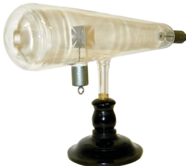
Figura 3 - Tubo de Crookes
