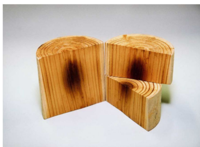
Figura 2.18 - Corte de uma tora de madeira após ser irradiada por micro-ondas por 3 minutos
