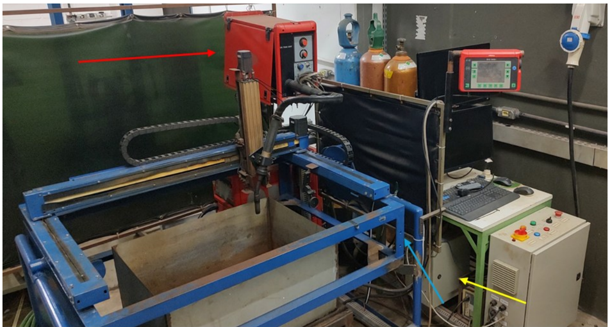
Figura 3.3 – Célula de soldagem, Fonte de soldagem (Vermelho), Mesa coordenada (Azul), Sistema de aquisição (Amarela). Fonte: O Autor.
