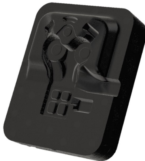
Figura 2.6 - Matriz de injeção de alumínio sob pressão. Fonte: O Autor.
