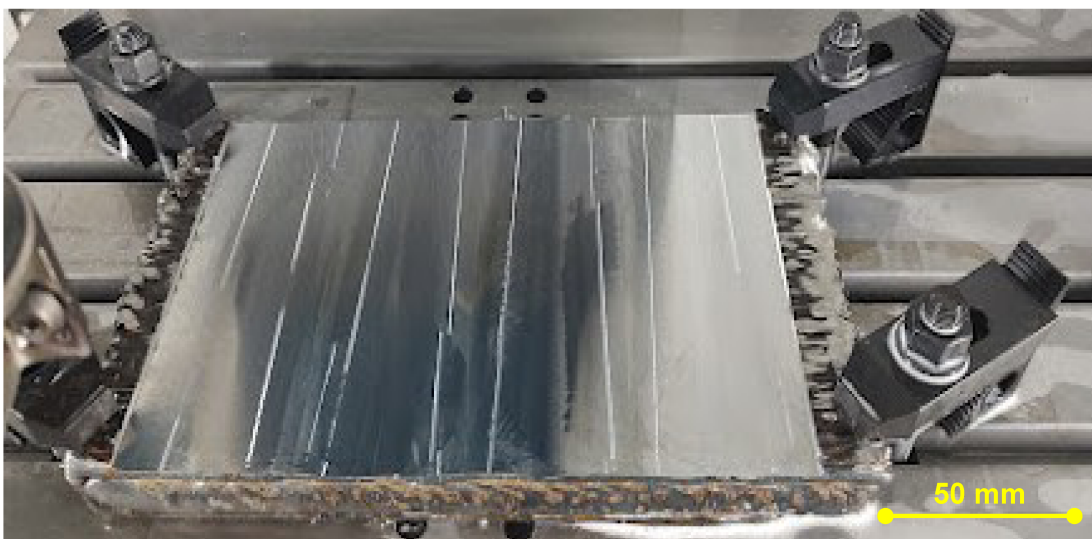
Figura 3.8 – Usinagem de pré-forma. Fonte: O Autor.
