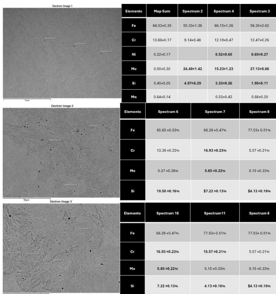
Figura 4.33 – Análise de composição química por EDS das inclusões da deposição do Aço Inoxidável 420. Fonte: O Autor
