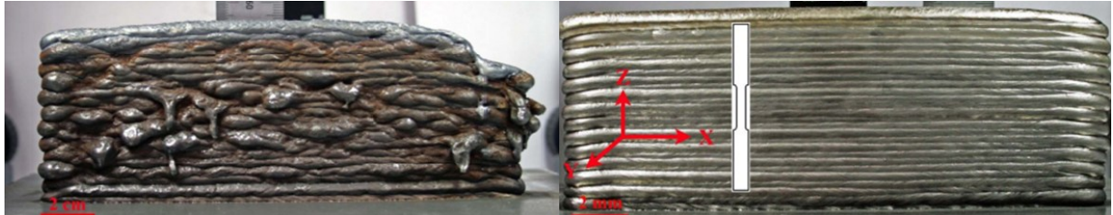
Figura 2.7 - Influência de óxidos na deposição. Fonte: XU, Xiangfang et al. (2018)
