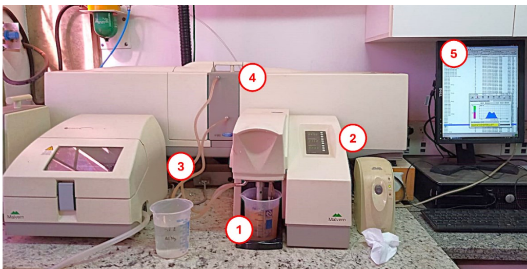
Figura 3.3 – Instrumentação para análise de distribuição granulométrica: 1) Solução de água e amostra, 2) Agitador Hidro 2000 MU, 3) Sistema de circulação da solução, 4) Analisador Mastersize 2000 e 5) Software de leitura Mastersize 2000.
