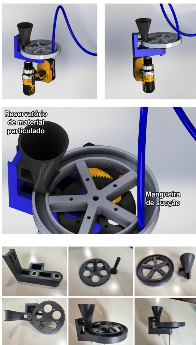
Figura 3.15 – Dispositivo de alimentação de material particulado.
