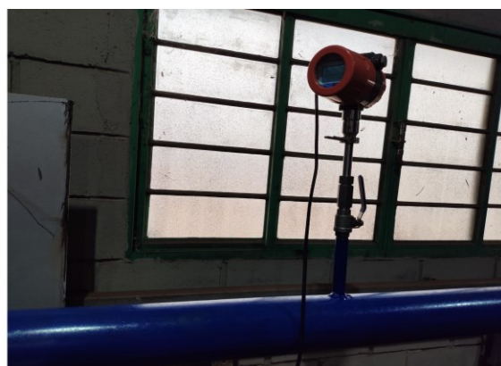
Figura 3.11 – Montagem da instrumentação da bancada para coleta da curva característica do soprador.
