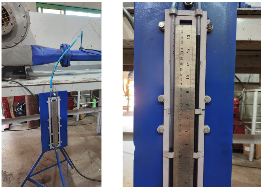
Figura 3.20 – Manômetro de coluna de água em U.
