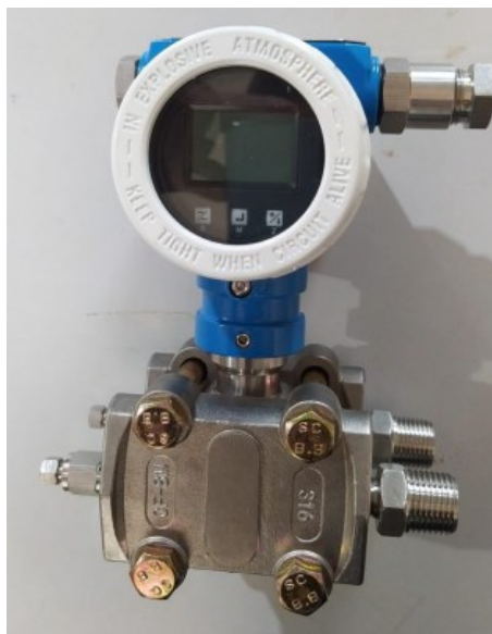
Figura 3.6 – Medidor de pressão utilizado para caracterização do soprador.
