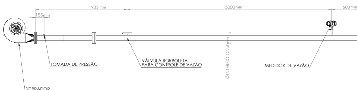
Figura 3.9 – Esquematização da bancada para coleta da curva característica do soprador – modelo com cotas.
