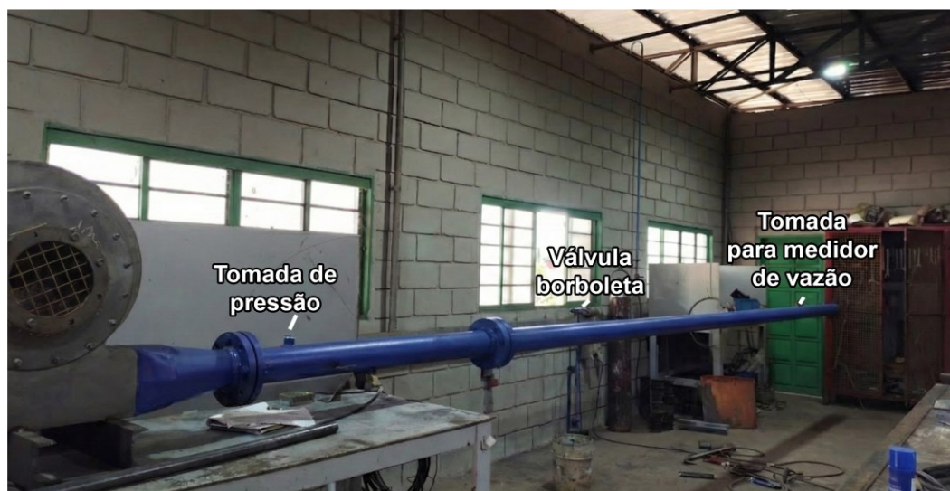
Figura 3.10 – Montagem da bancada para coleta da curva característica do soprador.
