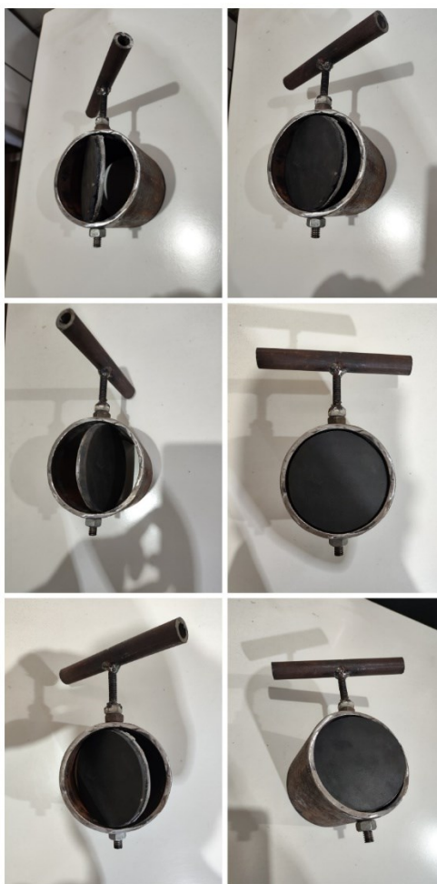
Figura 3.7 – Válvula borboleta para controle do fluxo de ar.
