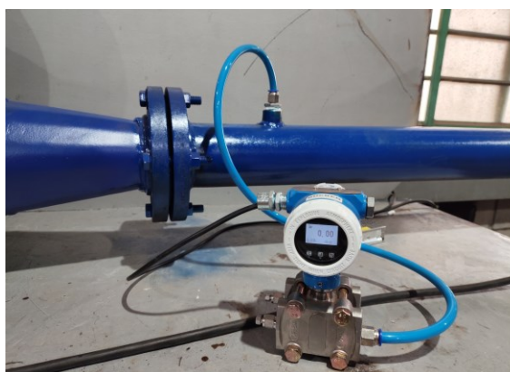
Figura 3.11 – Montagem da instrumentação da bancada para coleta da curva característica do soprador.
