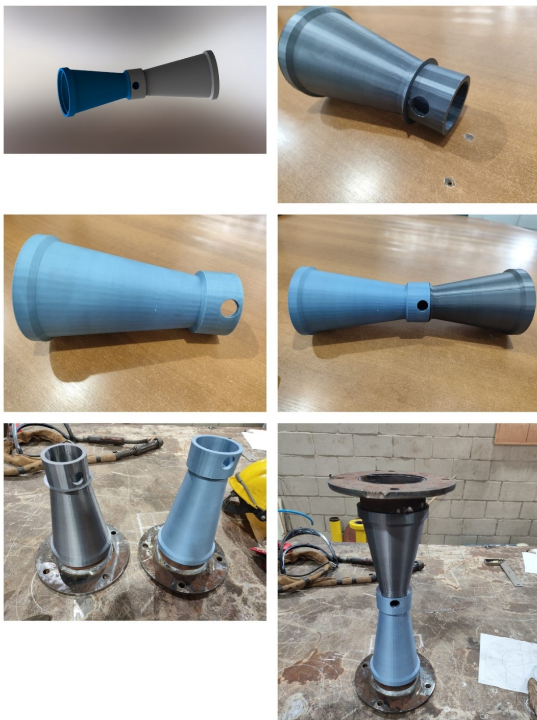
Figura 3.17 – Construção do tubo Venturi para sucção do material particulado.
