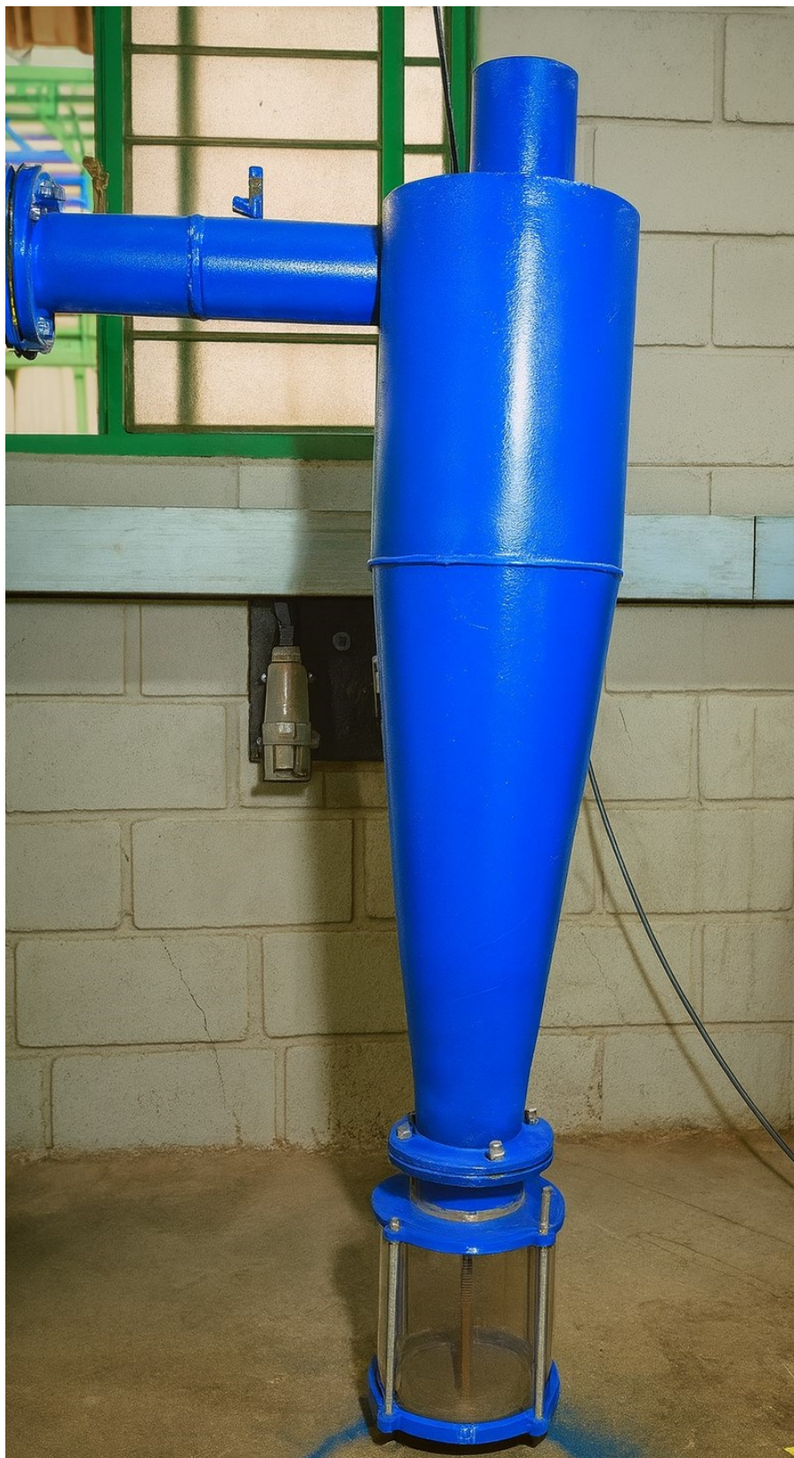
Figura 3.14 – Construção do ciclone protótipo.
