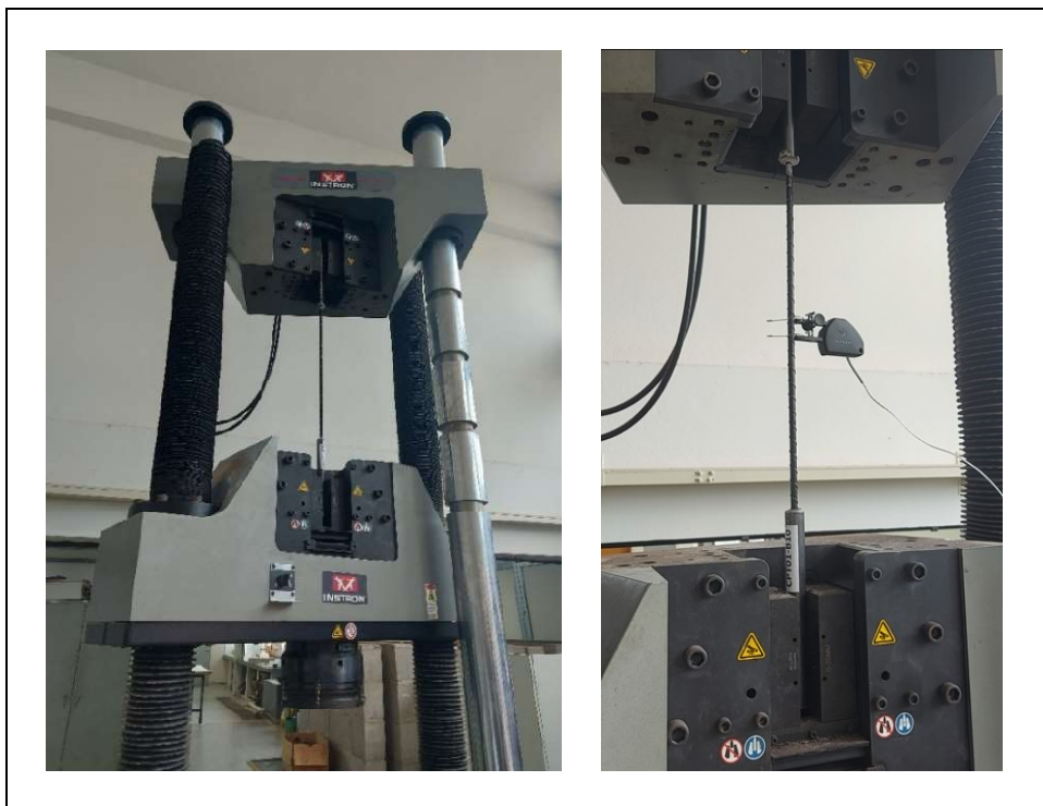
Figura 5.6 - Ensaio de tração das barras GFRP
