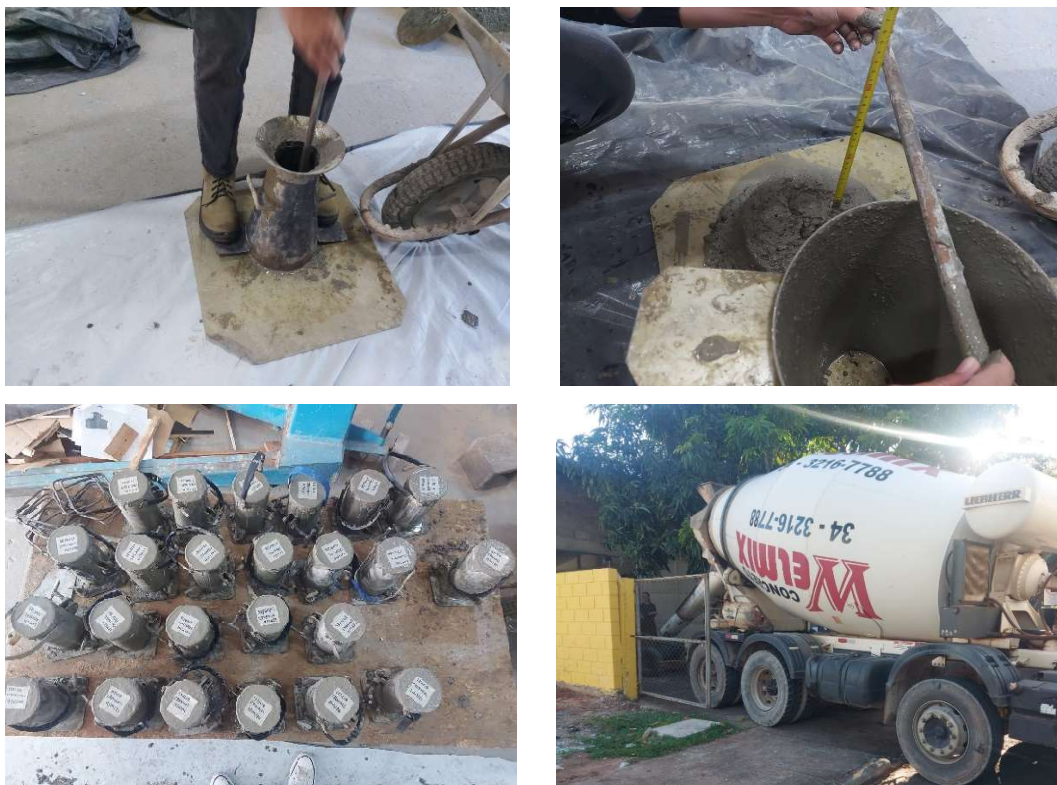
Figura 4.15 – Abatimento e moldagem dos corpos de prova do concreto dos blocos
