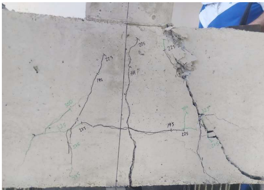
Figura 5.18 - Ruptura do modelo B3E2 GFRP-10
