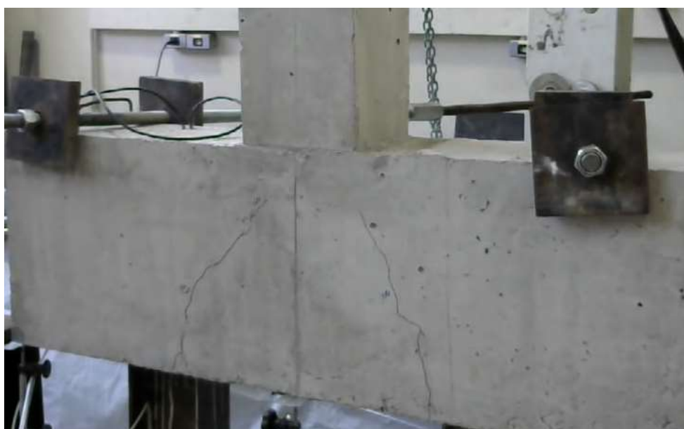
Figura 5.13 -Registro das primeiras fissuras no modelo B1E2 CA50-10
