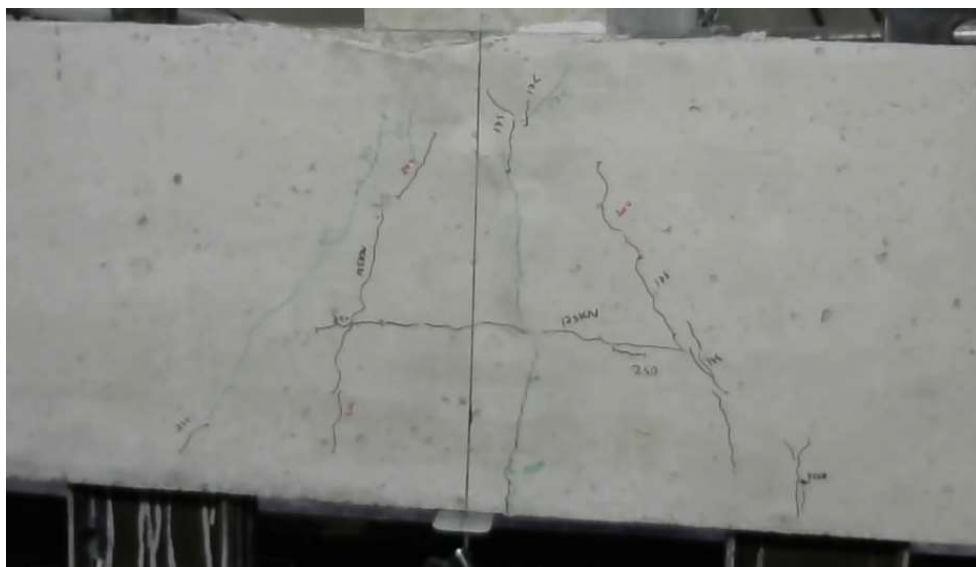
Figura 5.20 – Situação das fissuras no modelo B4E2 GFRP-10 quando o novo ensaio foi iniciado
