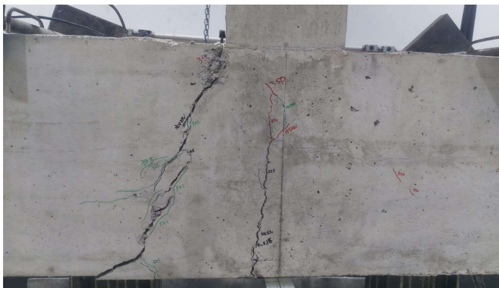
Figura 5.16 - Ruptura do modelo B2E2 CA50-10
