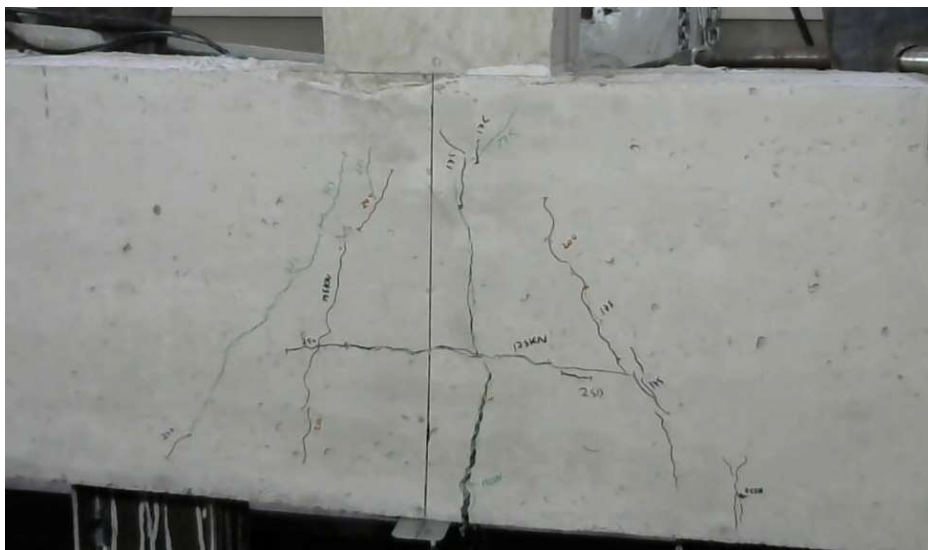
Figura 5.19 - Registro das primeiras fissuras no modelo B4E2 GFRP-10
