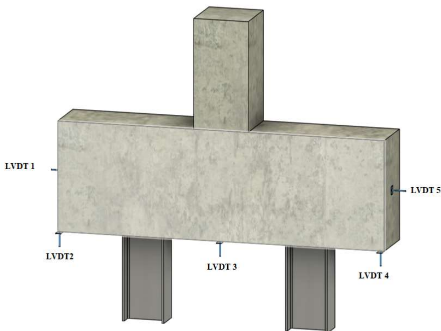
Figura 4.8 - Posição dos LVDTs nos modelos
