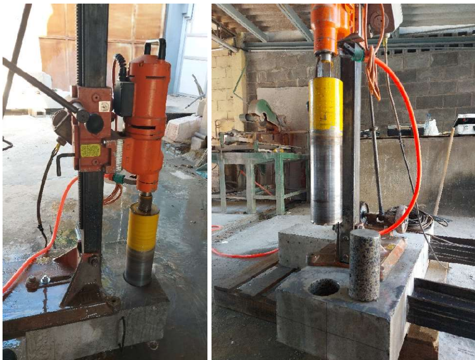
Figura 5.26 – Equipamento utilizado na extração dos testemunhos
