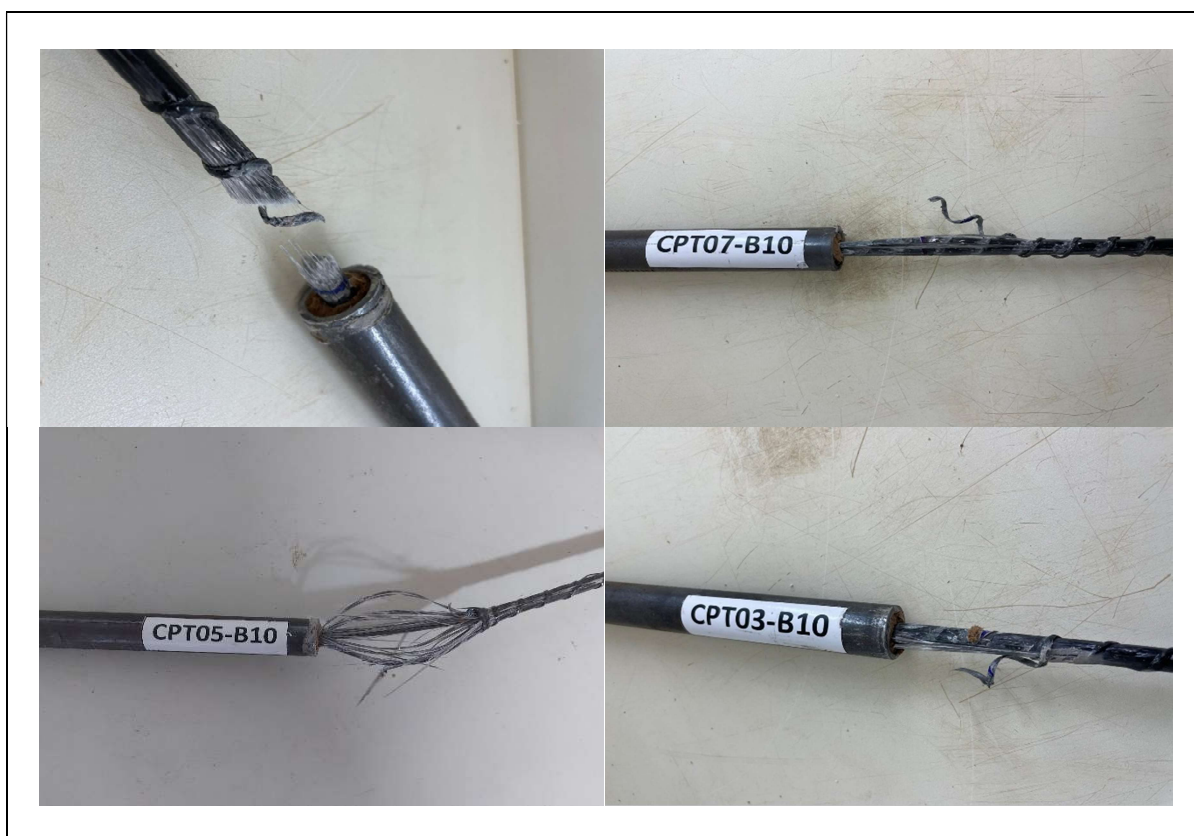
Figura 5.7 - Imagens de corpos de provas rompidos à tração
