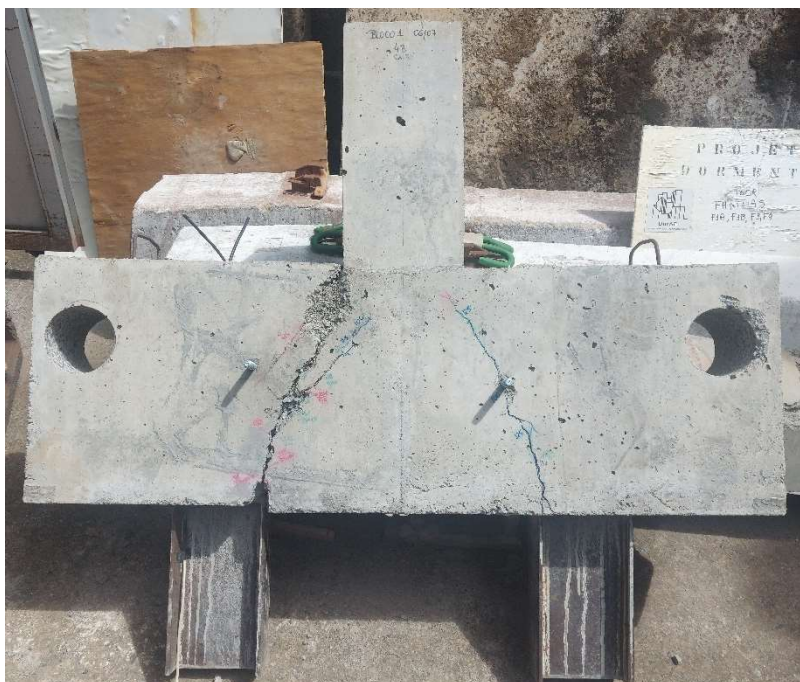
Figura 5.27 – Modelo B1E2 CA50-10 após a extração dos testemunhos
