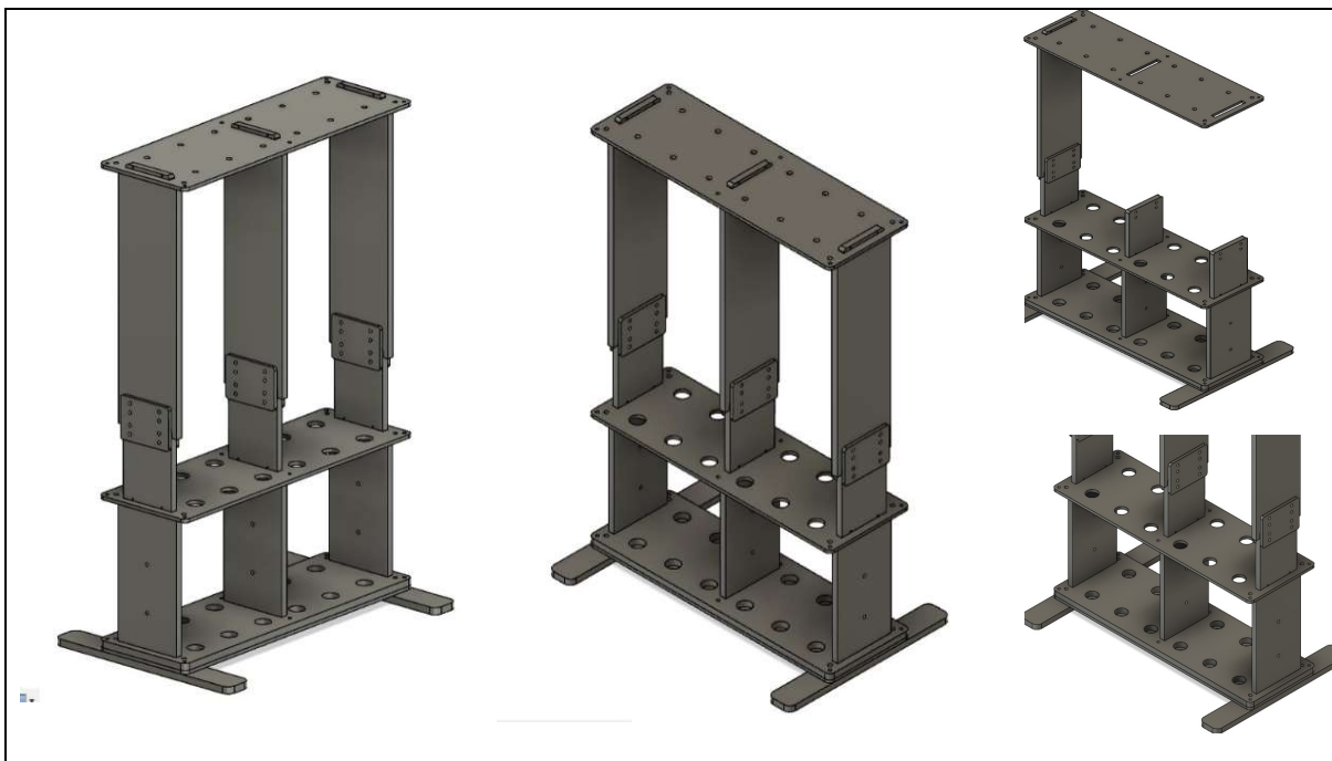
Figura 5.4 - Projeto do suporte para execução das ancoragens das amostras
