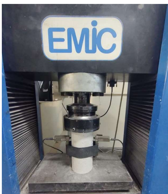
Figura 5.11 -Corpo de prova posicionado para ensaio com extensômetro removível
