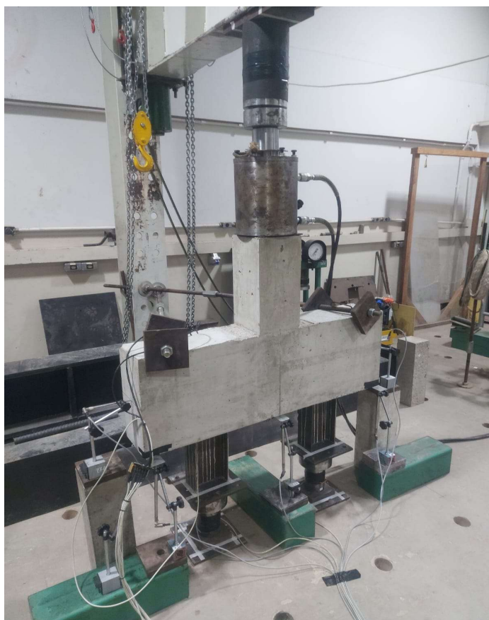
Figura 4.11 - Configuração final do sistema experimental, com o bloco devidamente instrumentado e preparado para o ensaio.
