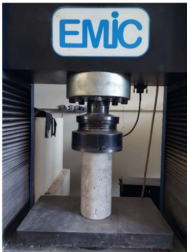
Figura 5.10 -Corpo de prova posicionado para ensaio de compressão
