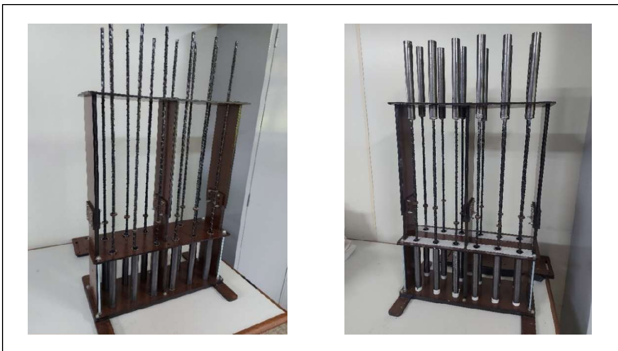
Figura 5.5 - Suporte em uso para a ancoragem das amostras
