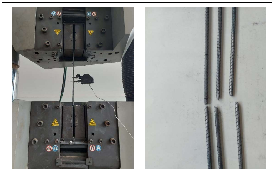
Figura 5.9 - Corpos de prova durante e após o ensaio de tração
