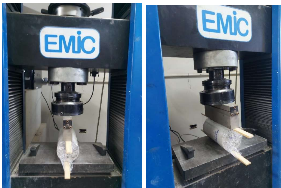
Figura 5.12 -Corpo de prova posicionado para ensaio compressão diametral
