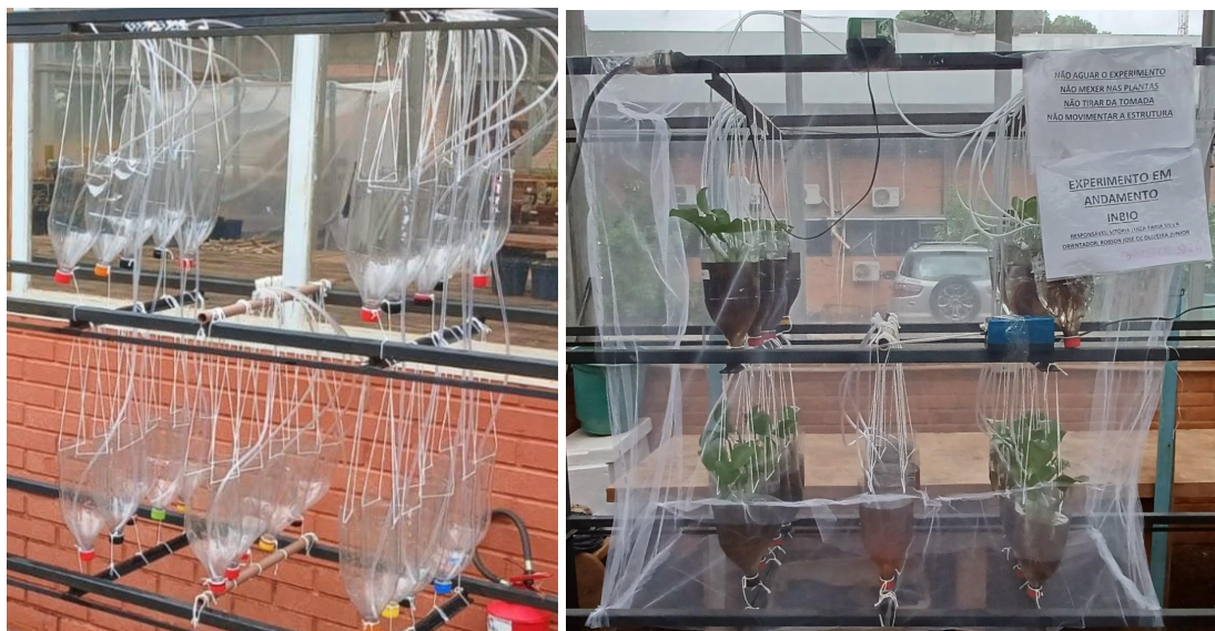
Figura 3: Sistema de Wetland construído. À esquerda o início da montagem do protótipo. À direita o protótipo em funcionamento com aguapés e amostras a serem biorremediadas. Fonte: autoria própria.
