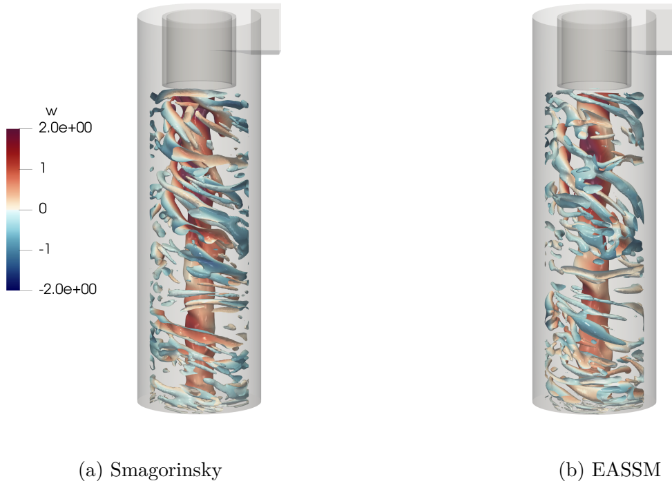
Figura 43 – Iso-superfícies do critério Q coloridas pela velocidade vertical ( w ) instantânea. Comparação entre os modelos Smagorinsky (à esquerda) e EASSM (à direita).
